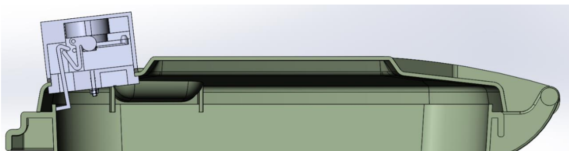
Slika 47. Prikaz bočnog presjeka koncepta 6 i spremnika
