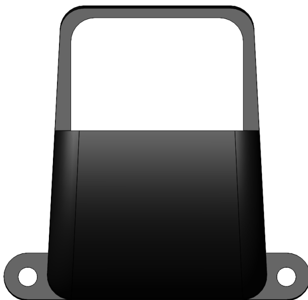
Slika 93. Prikaz poklopca za zaštitu izrađen ljevačkim kutom od 3 stupnja
