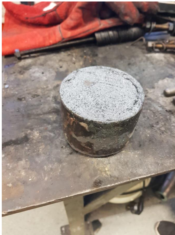
Slika 25. Uzorak u vatrootpornoj čeličnoj kutiji
