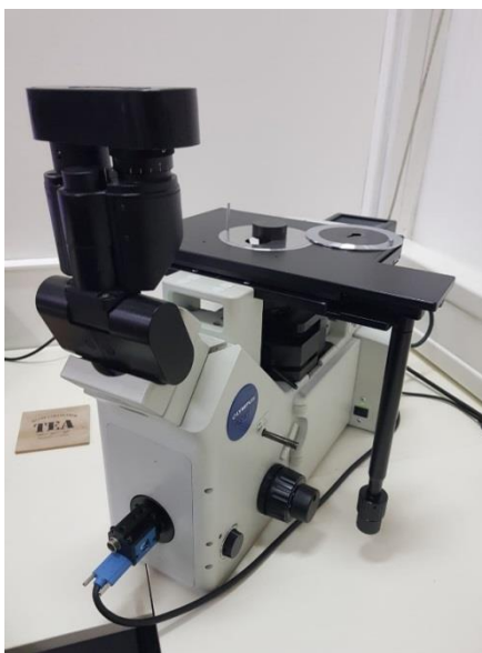
Slika 31. Metalografski mikroskop Olympus GX51
