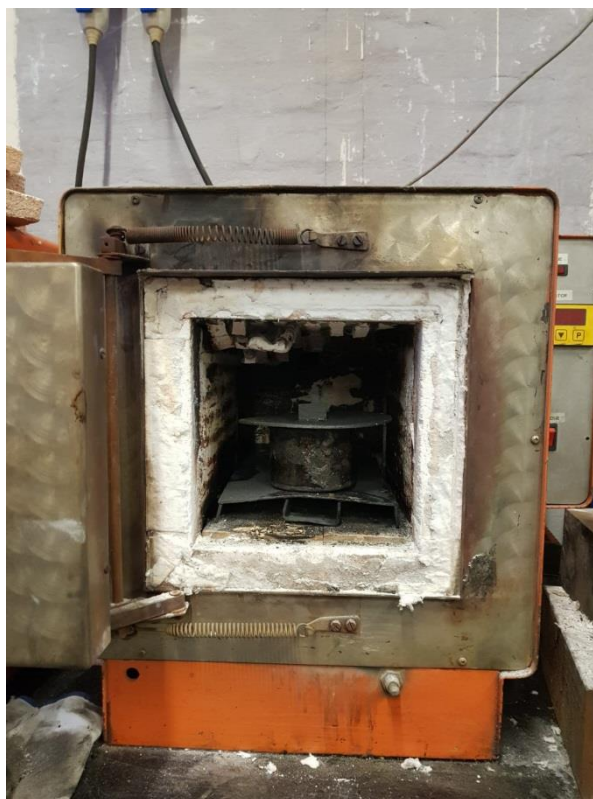
Slika 26. Kutija u komornoj peći prije boriranja
