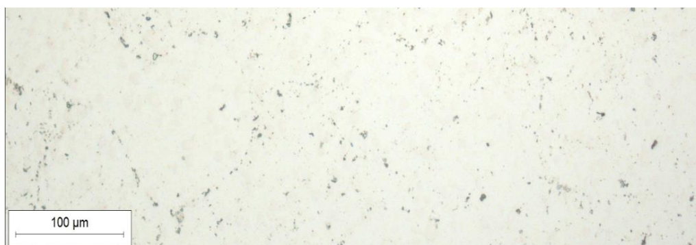
Slika 34. Jezgra boriranog čelika X90CrMoV18
