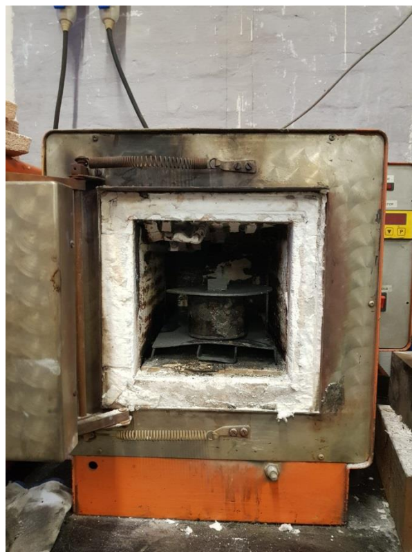
Slika 26. Kutija u komornoj peći prije boriranja
