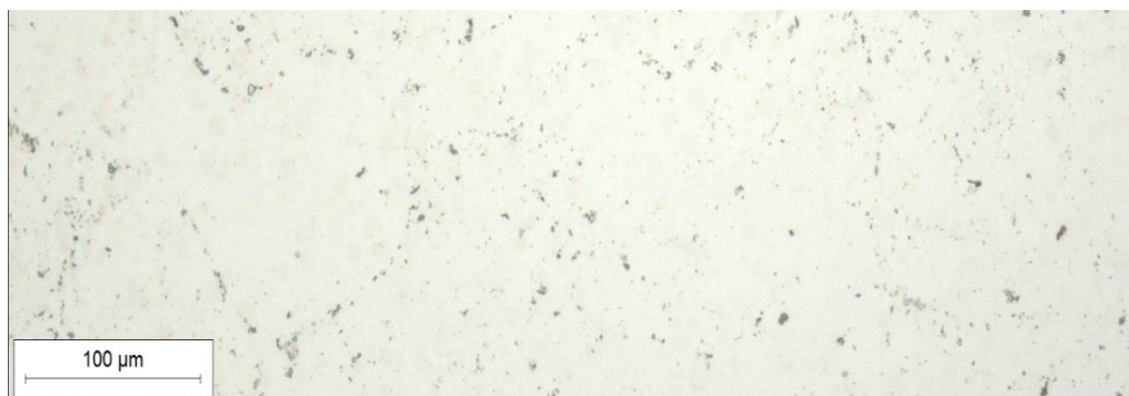
Slika 34. Jezgra boriranog čelika X90CrMoV18
