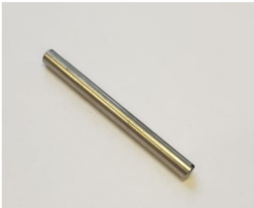
Slika 24. Uzorak od čelika X90CrMoV18 prije boriranja
