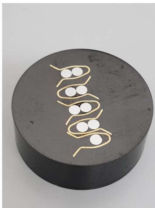
Slika 29. Uzorci u polimernoj masi
