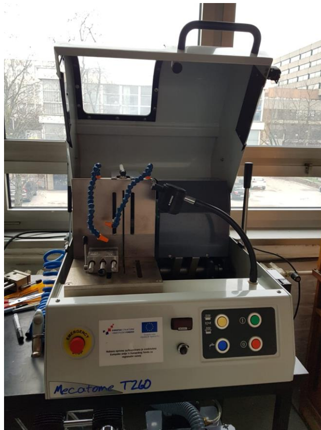
Slika 28. Uređaj za izrezivanje
