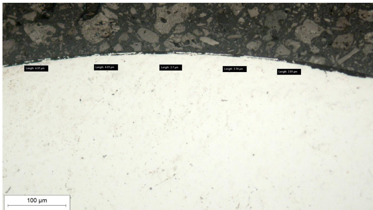
Slika 36. Uzorak 4, boriran na T = 900\text{ °C}/1\text{h} , povećanje 200x, nagriženo u 3 %-tnom NITAL-u
