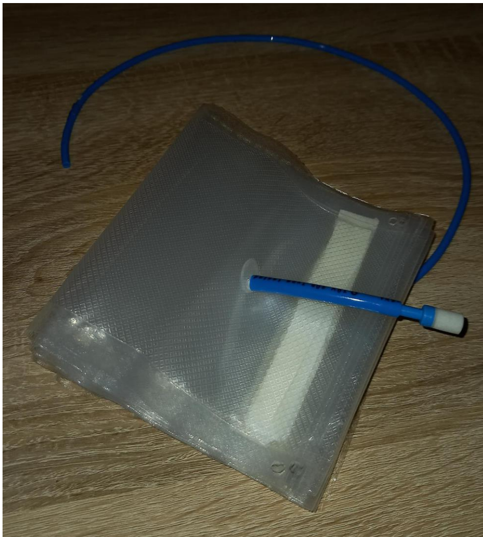
Slika 25. Nenapuhani fleksibilni pneumatski aktuator sa zatvorenim izlazom
