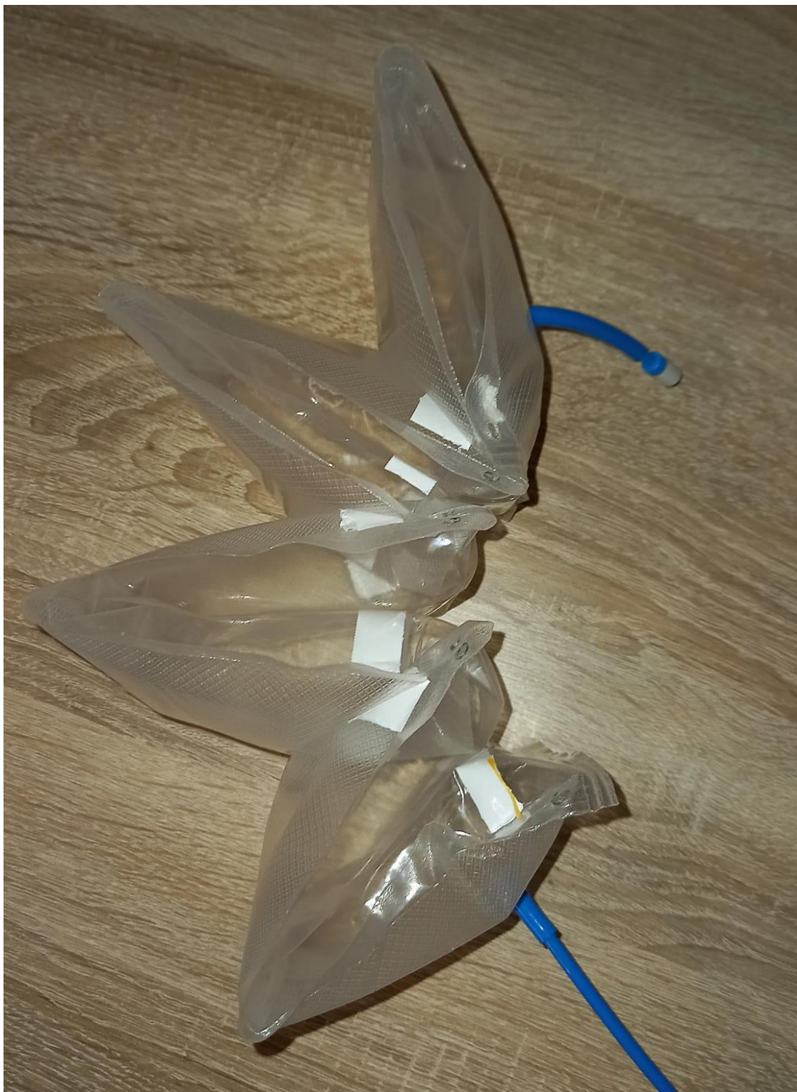
Slika 26. Napuhani fleksibilni pneumatski aktuator (1)
