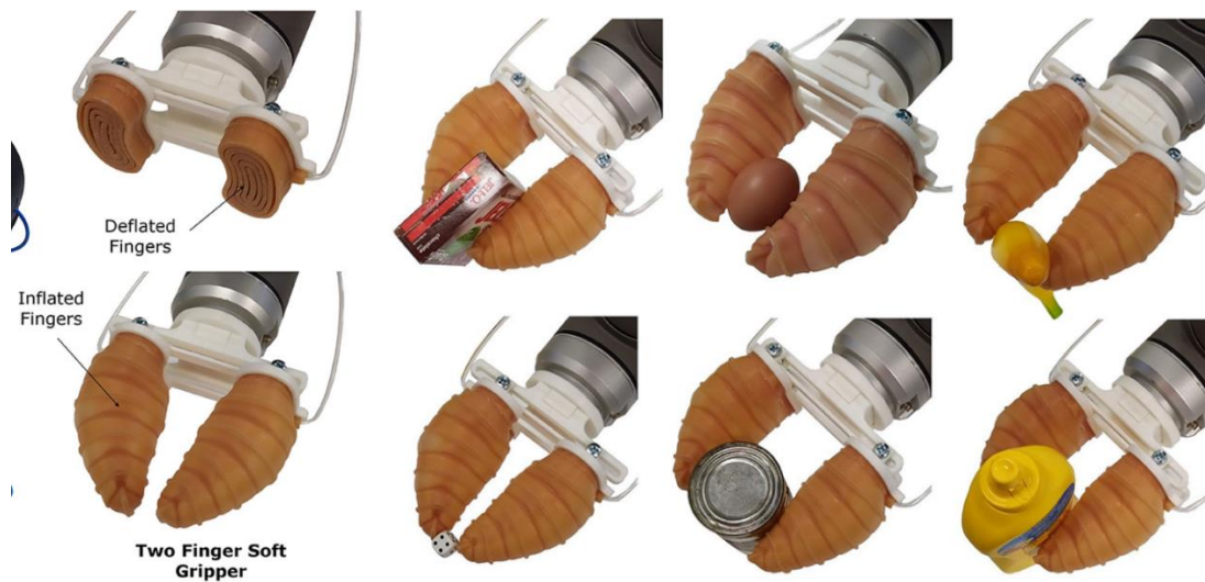
Slika 5. Fleksibilna hvataljka za hvatanje objekata raznih veličina i oblika [5]
