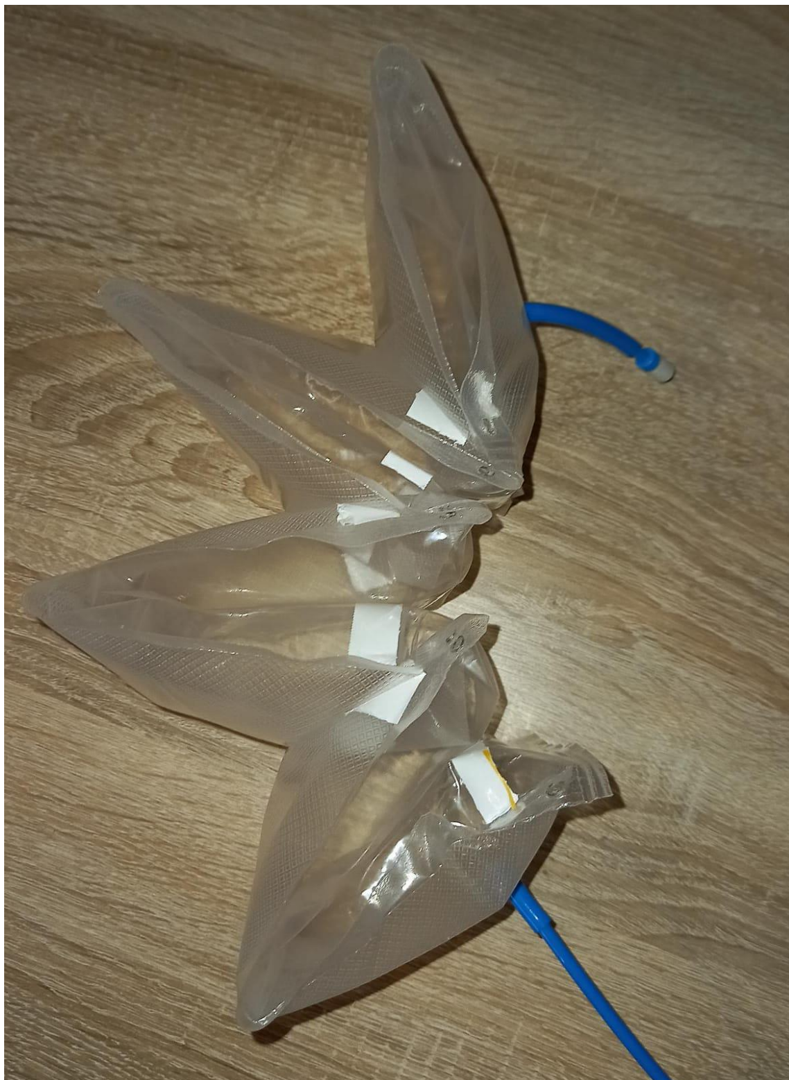
Slika 26. Napuhani fleksibilni pneumatski aktuator (1)
