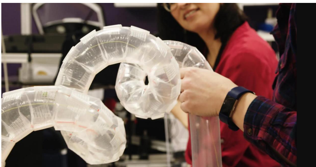
Slika 11. Vinebot- primjer korištenja aktuatora na napuhavanje u robotici [11]
