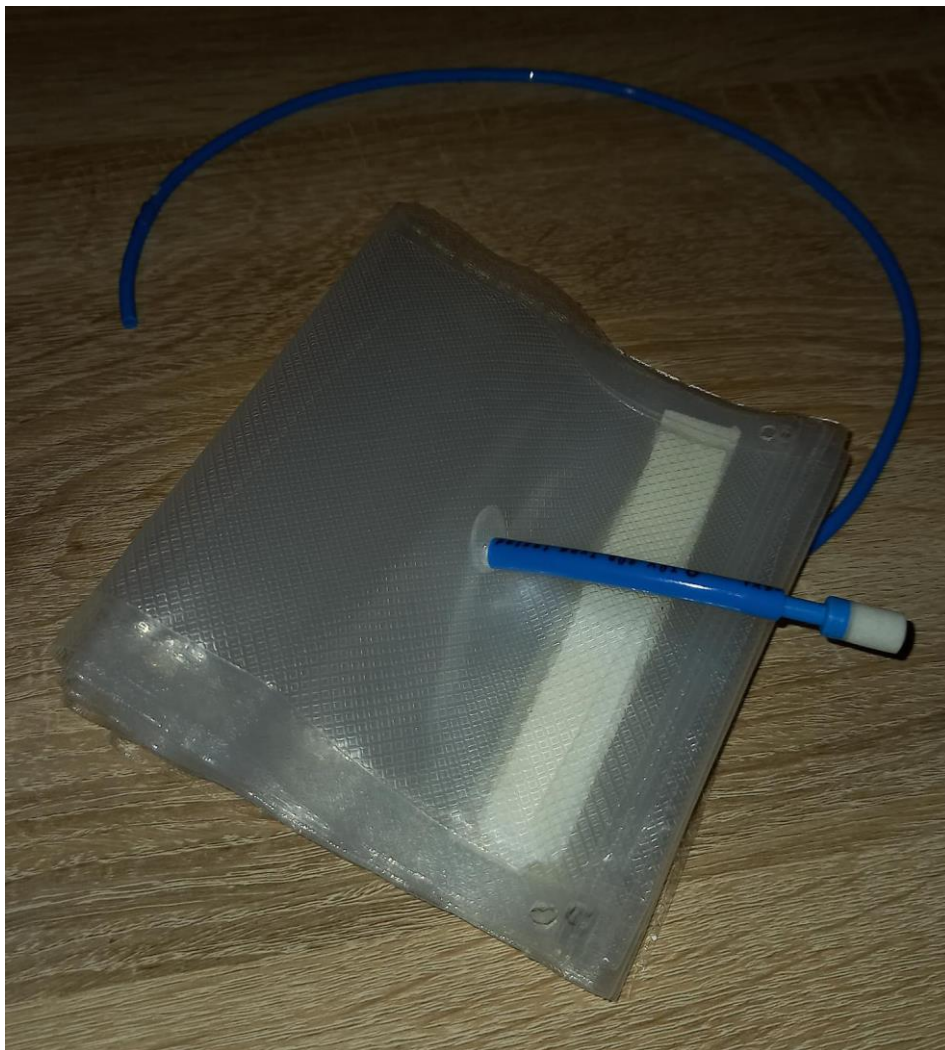
Slika 25. Nenapuhani fleksibilni pneumatski aktuator sa zatvorenim izlazom
