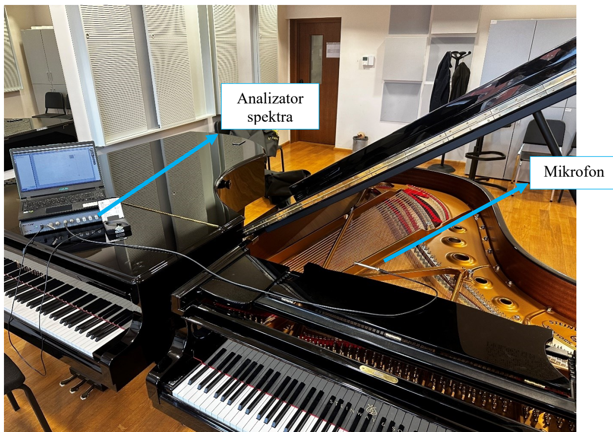
Slika 28. Prikaz mjerenja fundamentalnih frekvencija tonova na klaviru modela Steinway & Sons pomoću analizatora spektra
