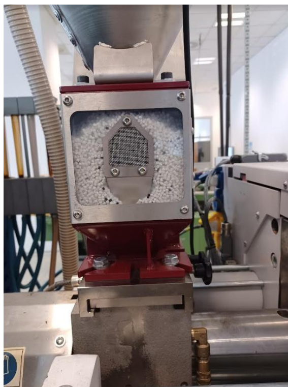
Slika 3. Granule PBT materijala
