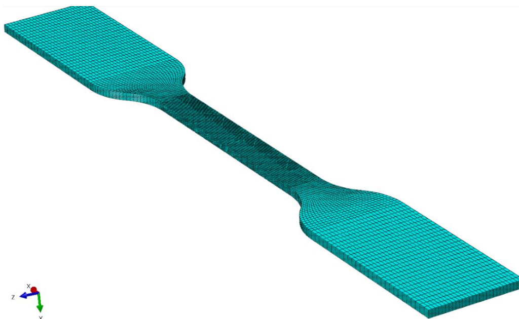
Slika 41. Mreža konačnih elemenata epruvete – 30016 C3D8 elementa
