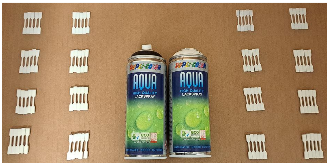
Slika 9. Epruvete pripremljene za nanošenje rastera
