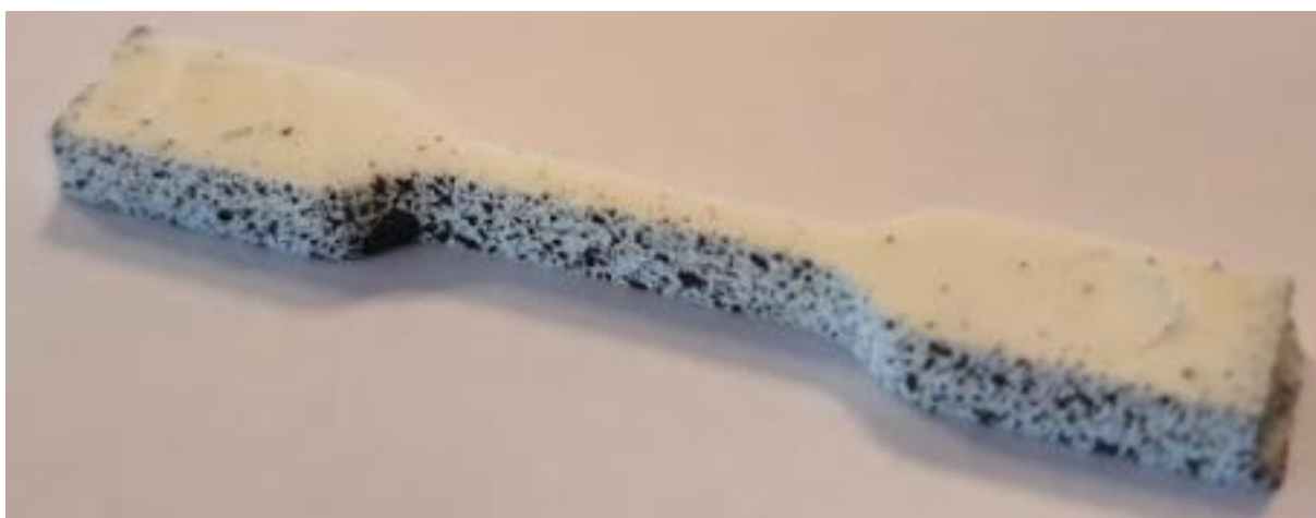
Slika 15. Epruveta pripremljena za test savijana u tri točke
