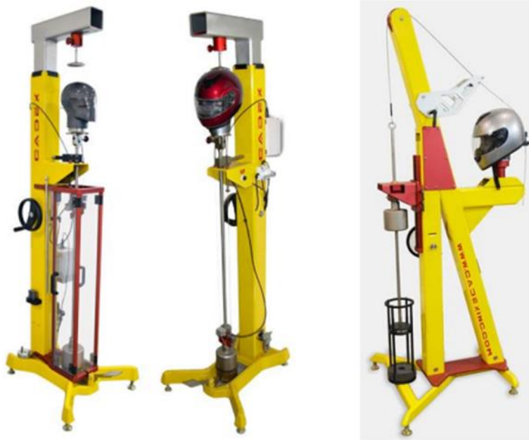
Slika 31. Naprave za testiranje čvrstoće remena (lijevo) i stabilnosti (desno) [23]
