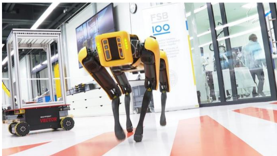
Slika 1. Prikaz robota hodača s četiri noge (Spot)[20]
