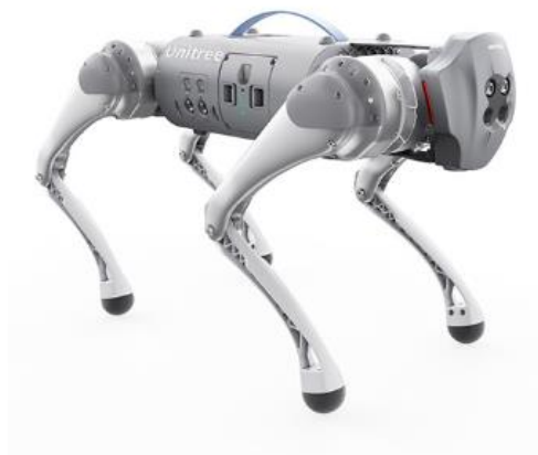
Slika 11. Unitree Go1 robot[6]
