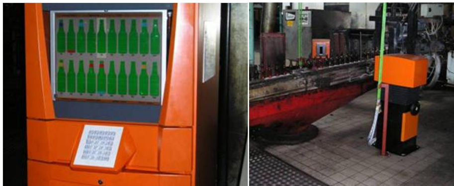
Slika 3. XPAR Vision sustav za kontrolu prvog stupnja
