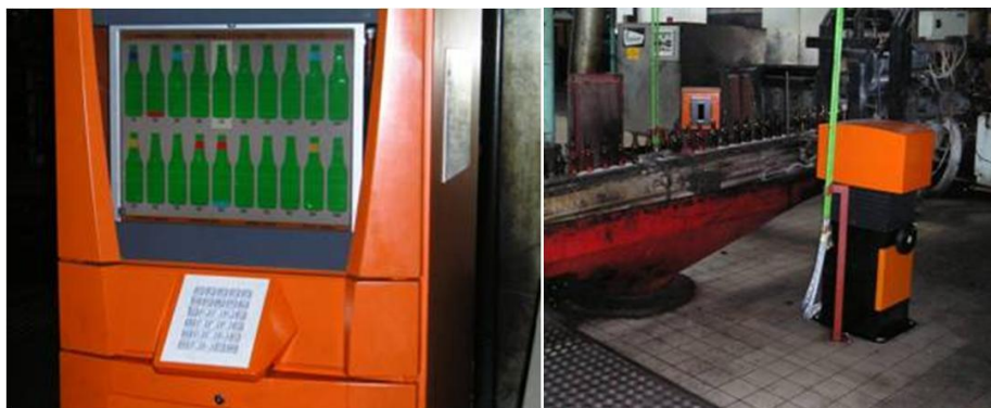
Slika 3. XPAR Vision sustav za kontrolu prvog stupnja
