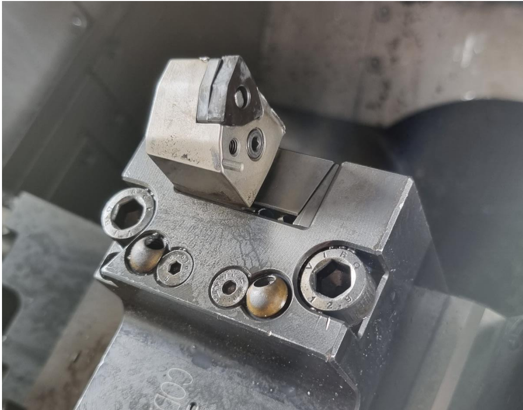
Slika 28. Alat za poravnavanje i grubu vanjsku obradu stražnje strane
