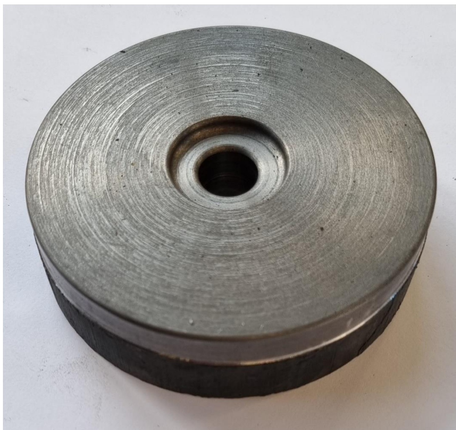
Slika 20. Utor za metalizaciju na obratku
