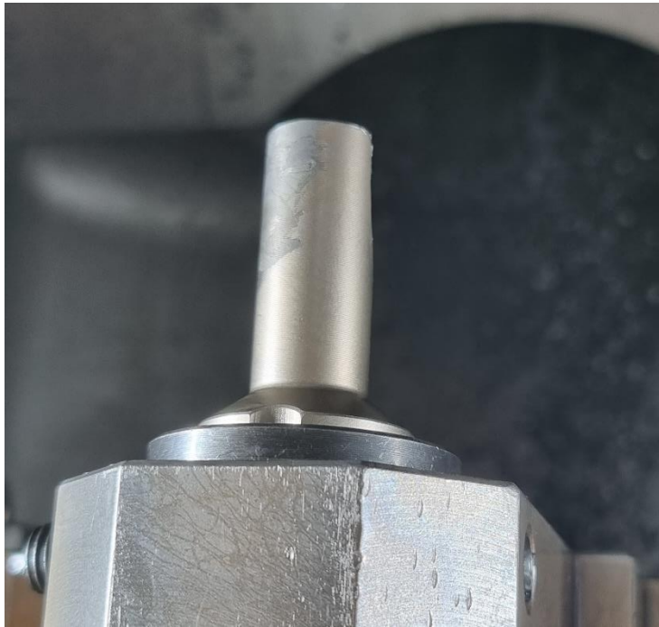
Slika 32. Alat za grubu obradu unutarnje konture stražnje strane
