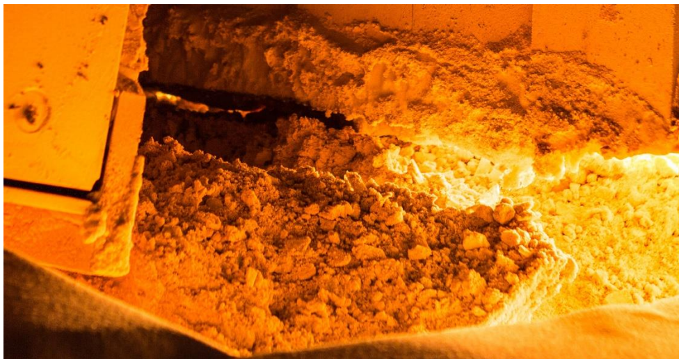
Slika 1. Taljenje staklene smjese
