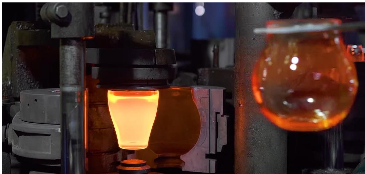
Slika 2. Predoblik na ulasku u kalupnu stranu
