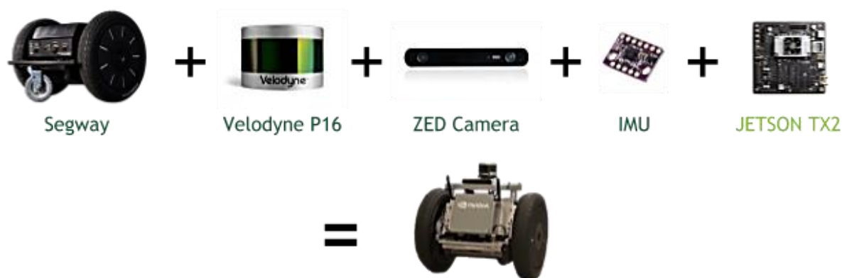
Slika 12. Komponente sustava mobilnog robota Carter. [16]
