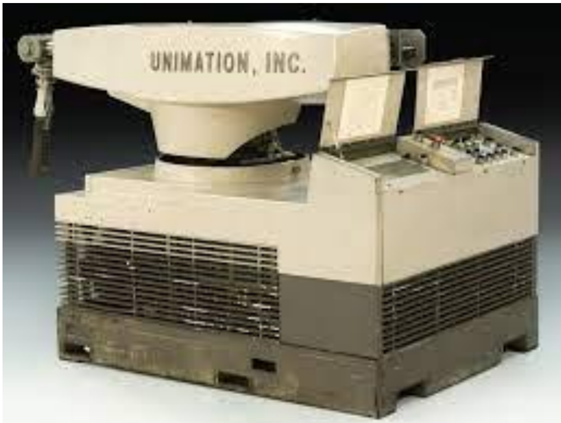
Slika 1. Prvi industrijski moderni robot Unimate [7]
