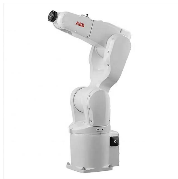
Slika 2. ABB manipulator RRR strukture [8]
