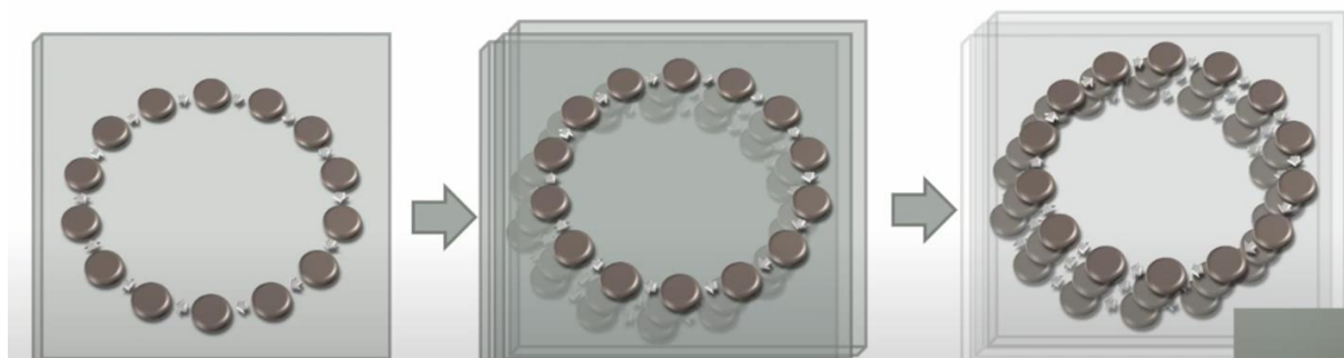
Slika 4: Inkjet bioispis - slojevito
