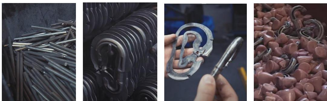
**Slika 12. Proizvodnja karabinera (slijeva na desno: šipka koja se savija, kovani komad, odvojeni srh, vibracijsko poliranje keramičkim stošcima) [16]**
