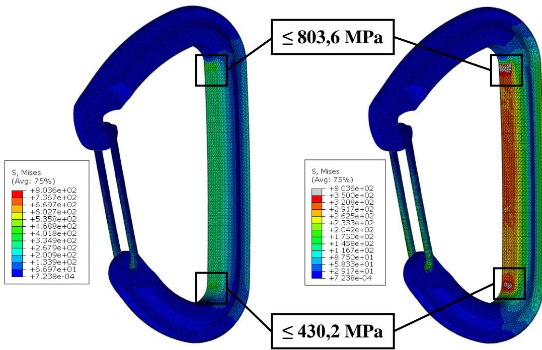
**Slika 21.** a) Naprezanja u zatvorenom karabineru
