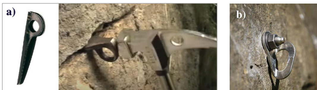
Slika 8. a) Klin se zabija kladivom i koristi kao međuosiguranje (neopremljeni smjerovi) [11][12]
