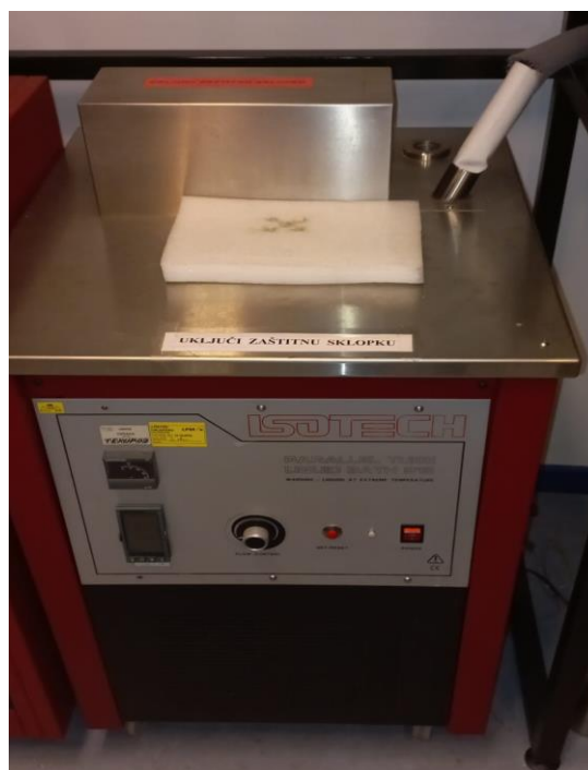
Slika 19. Korištena etanolska kupka
