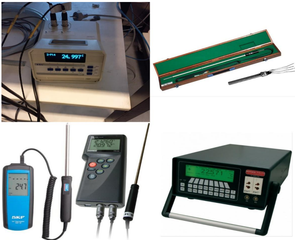
Slika 5. Prikaz nekoliko termometara s otporničkim osjetnicima
