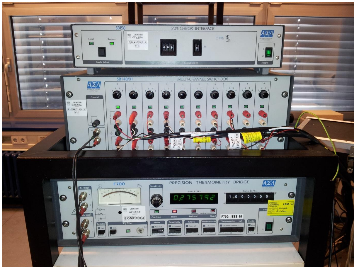
Slika 17. Termometrijski otpornički most etalonskog termometra
