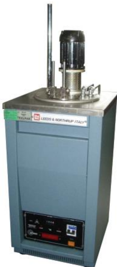
Slika 21. Fotografija uljne kupke
