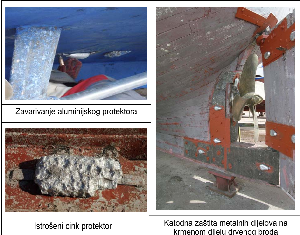
Slika 16. Katodna zaštita broda žrtvovanim anodama [3,7]
