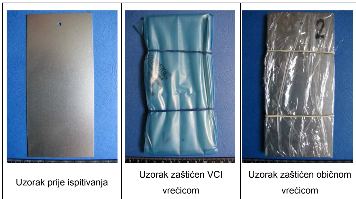
Slika 44. Priprema uzoraka prije ispitivanja u morskoj atmosferi [3]
