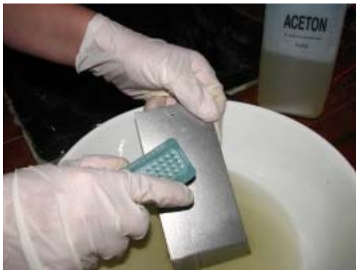
Slika 34. Detalj odmašćivanja uzoraka u posudi s acetonom u Laboratoriju za zaštitu materijala, FSB [3]
