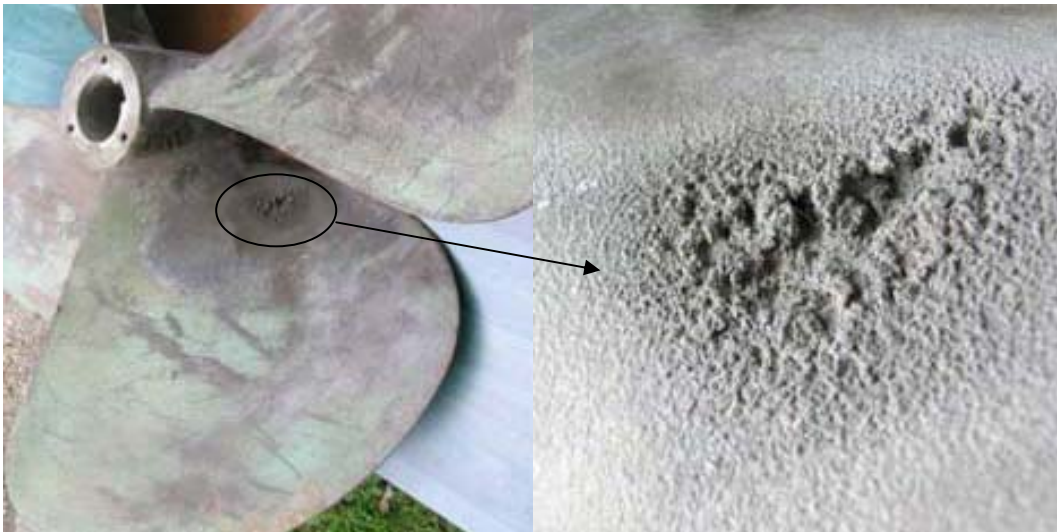
Slika 2. Kavitacijska korozija krila brodskog vijka ribarskog broda [4]
