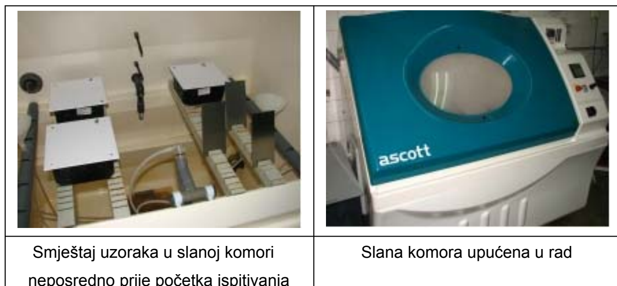
Slika 40. Slana komora u Laboratoriju za zaštitu materijala Fakulteta strojarstva i brodogradnje u Zagrebu [3]
