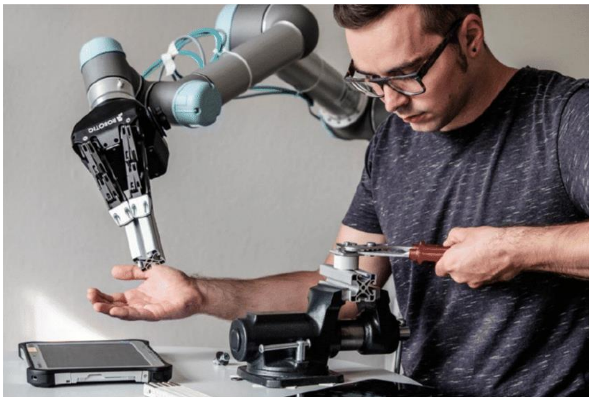
Slika 3. Kolaboracija robota i čovjeka na radnoj stanici za montažu [7]
