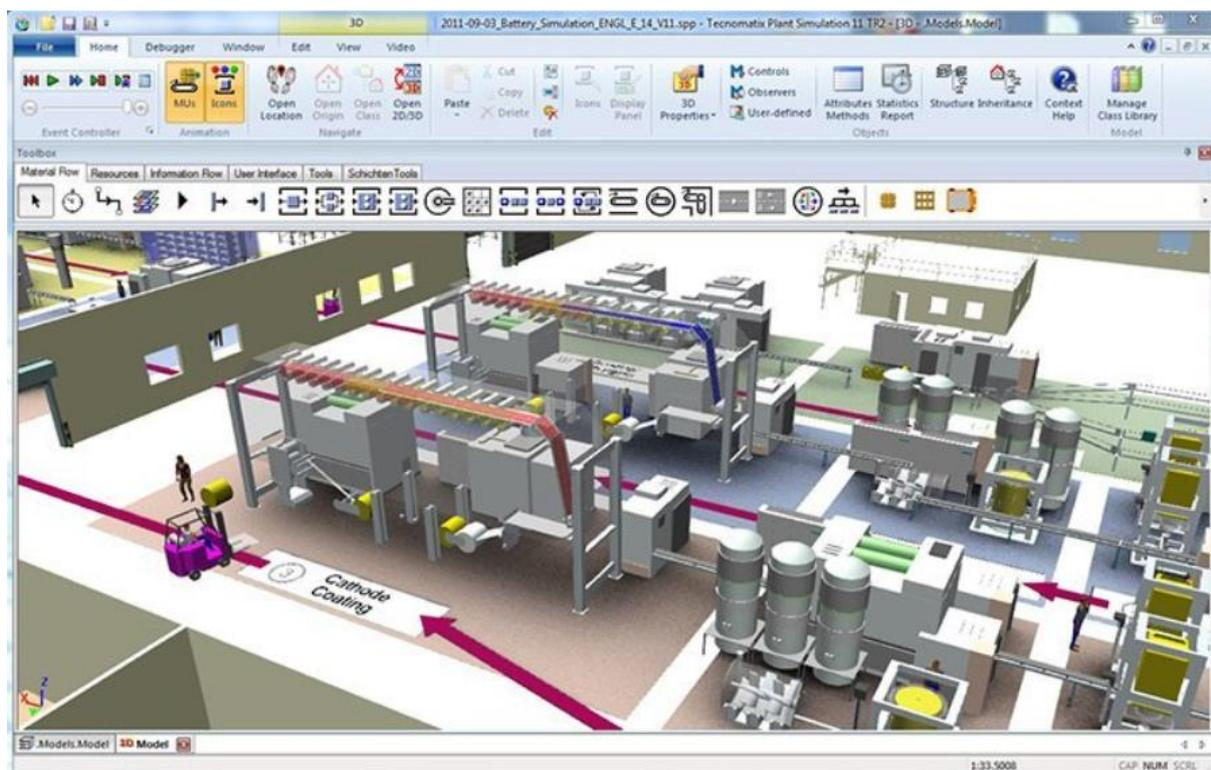
**Slika 5. Simulacija pogona u Siemens Tecnomatix [13]**
