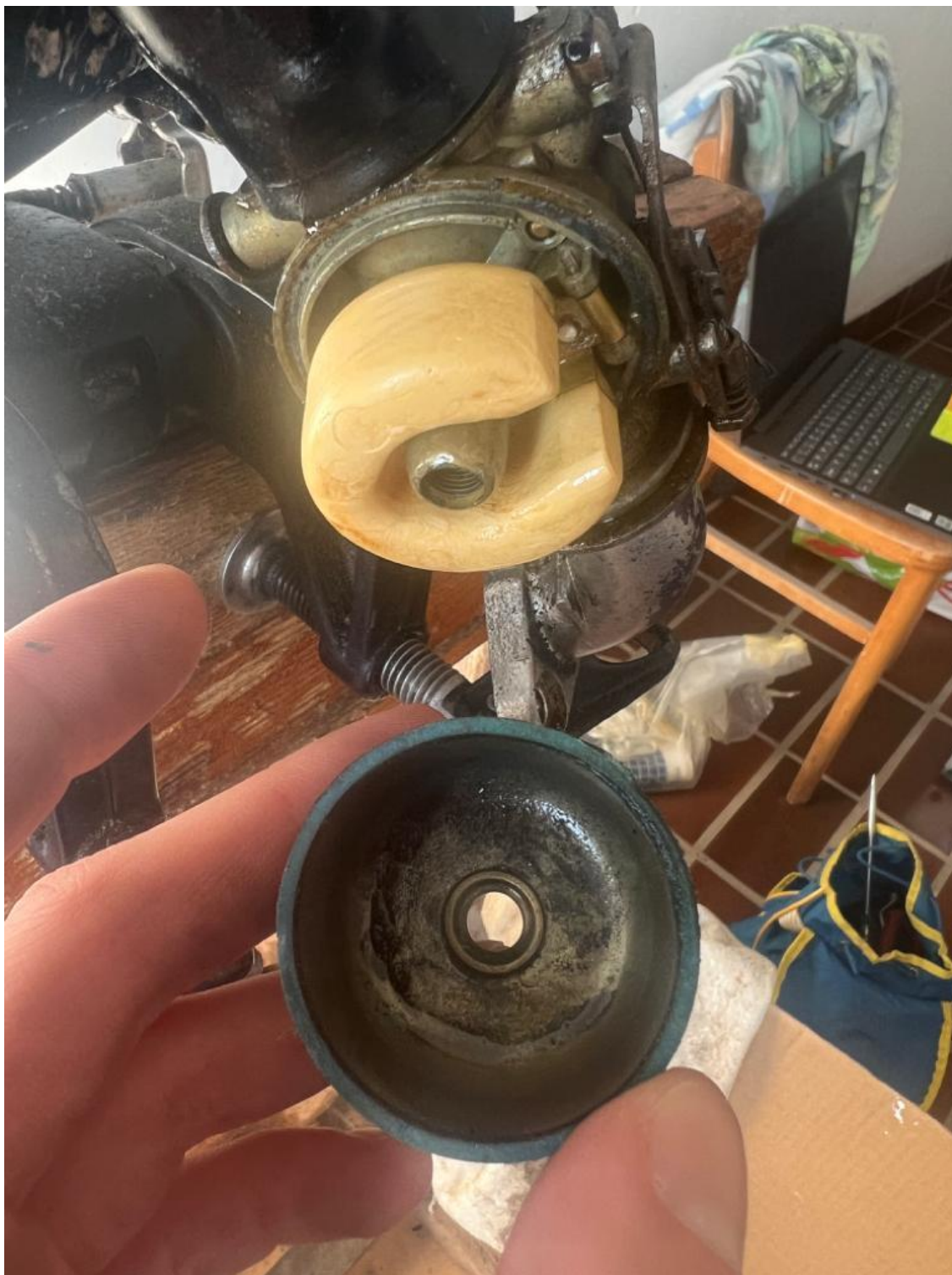
Slika 26. Nečistoća u posudi rasplinjača
