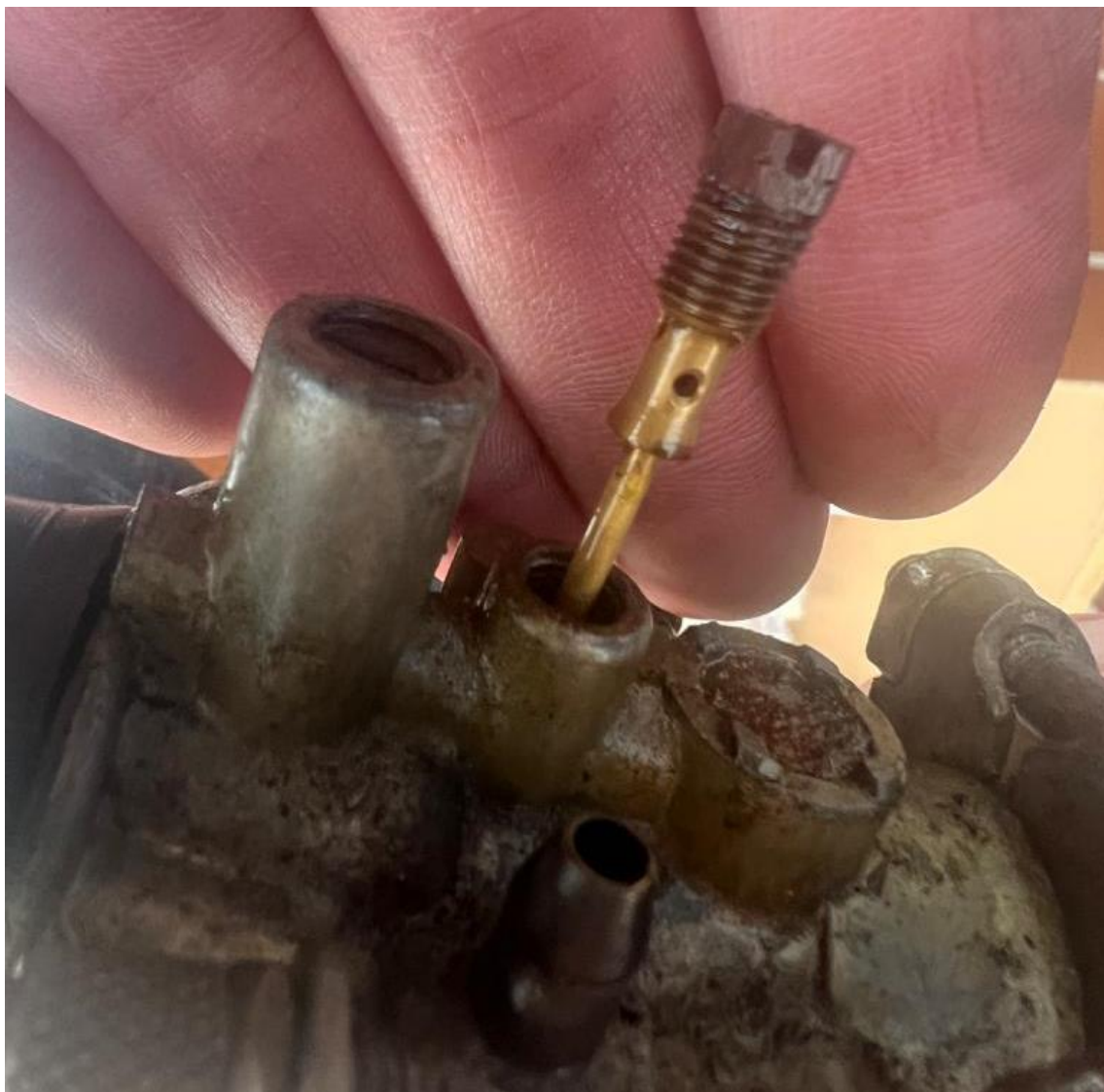
Slika 27. Mlaznica (dizna) rasplinjača
