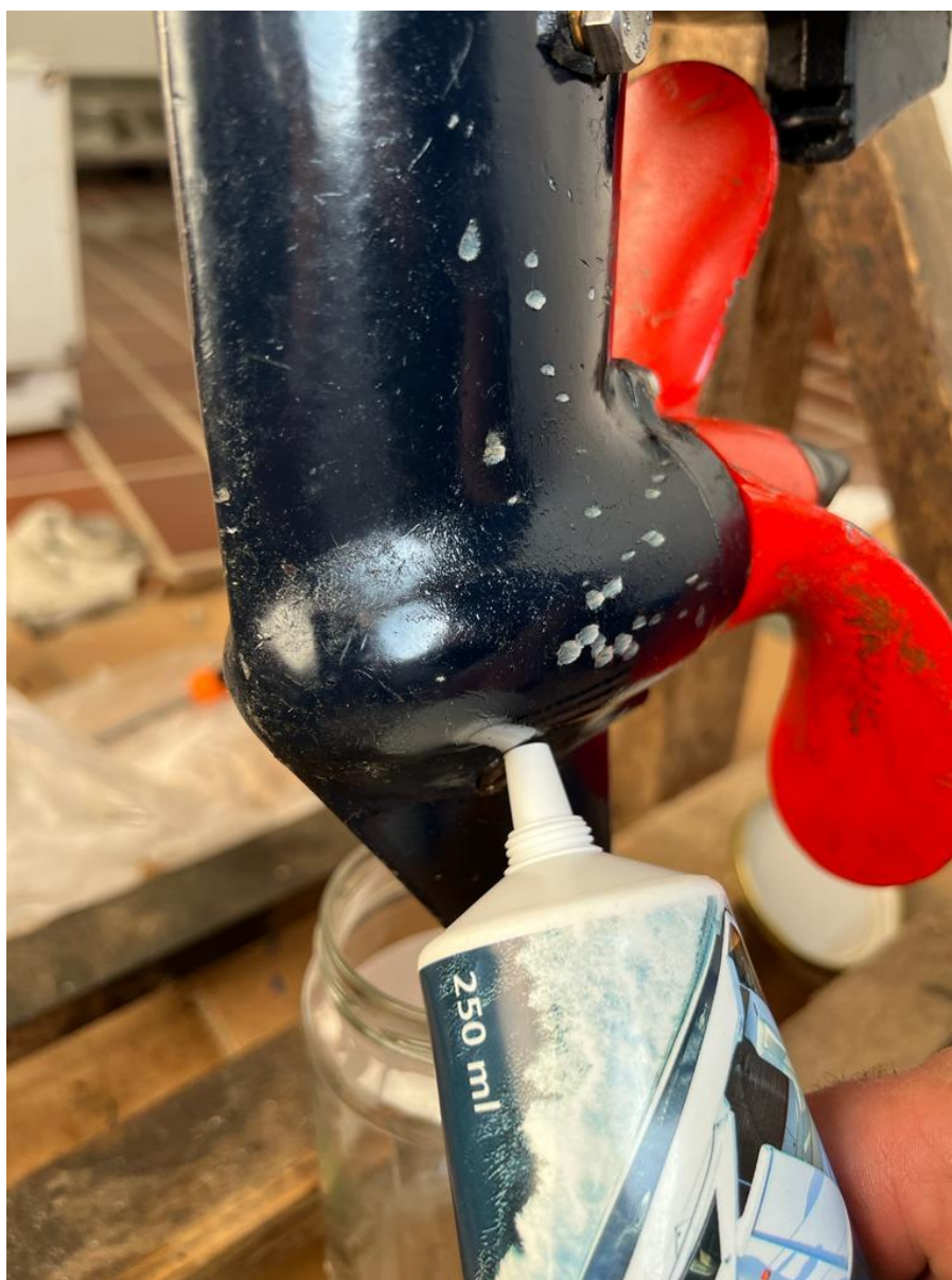
Slika 30. Zamjena ulja u peti motora
