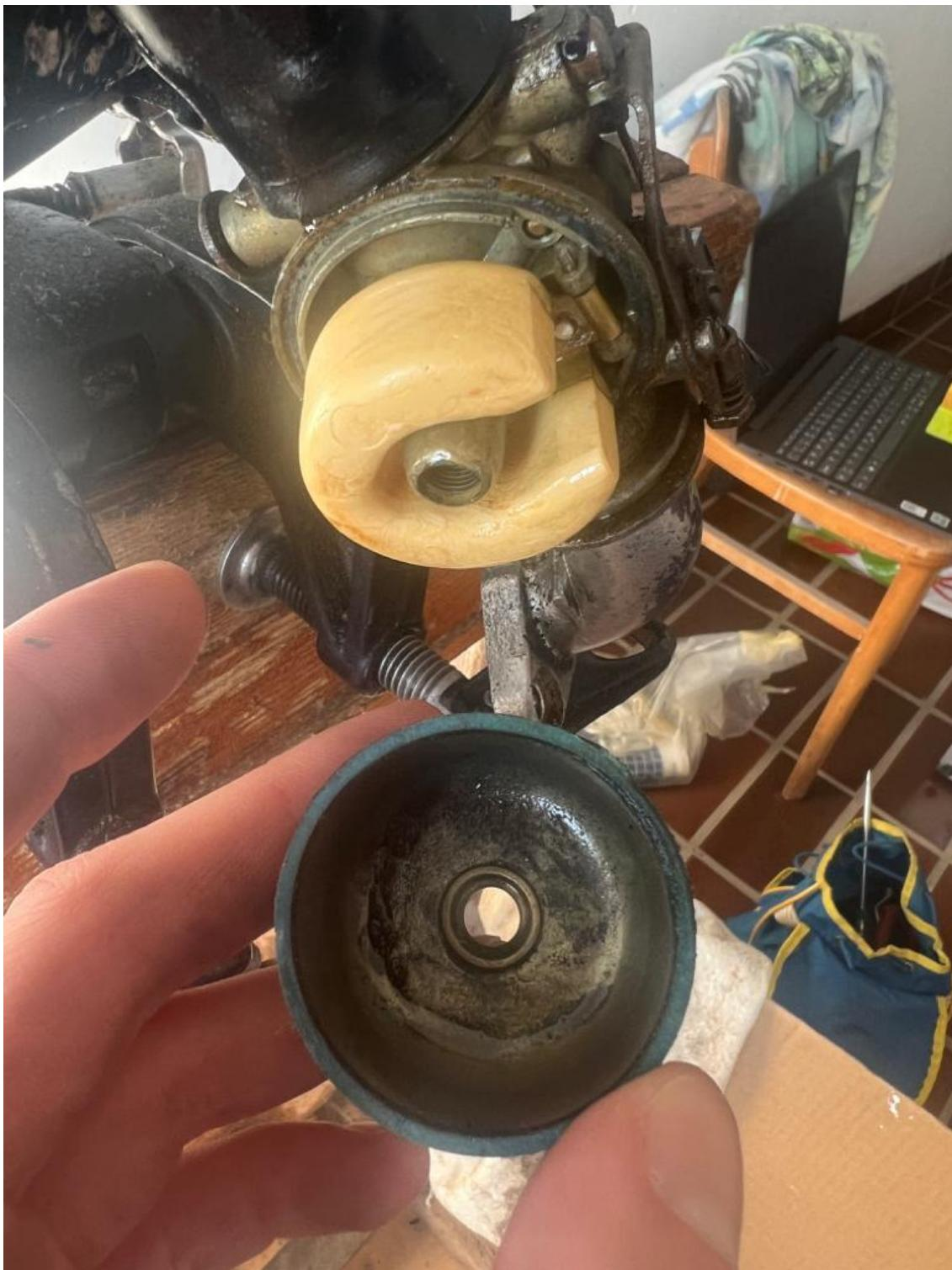
**Slika 26.** Nečistoća u posudi rasplinjača
