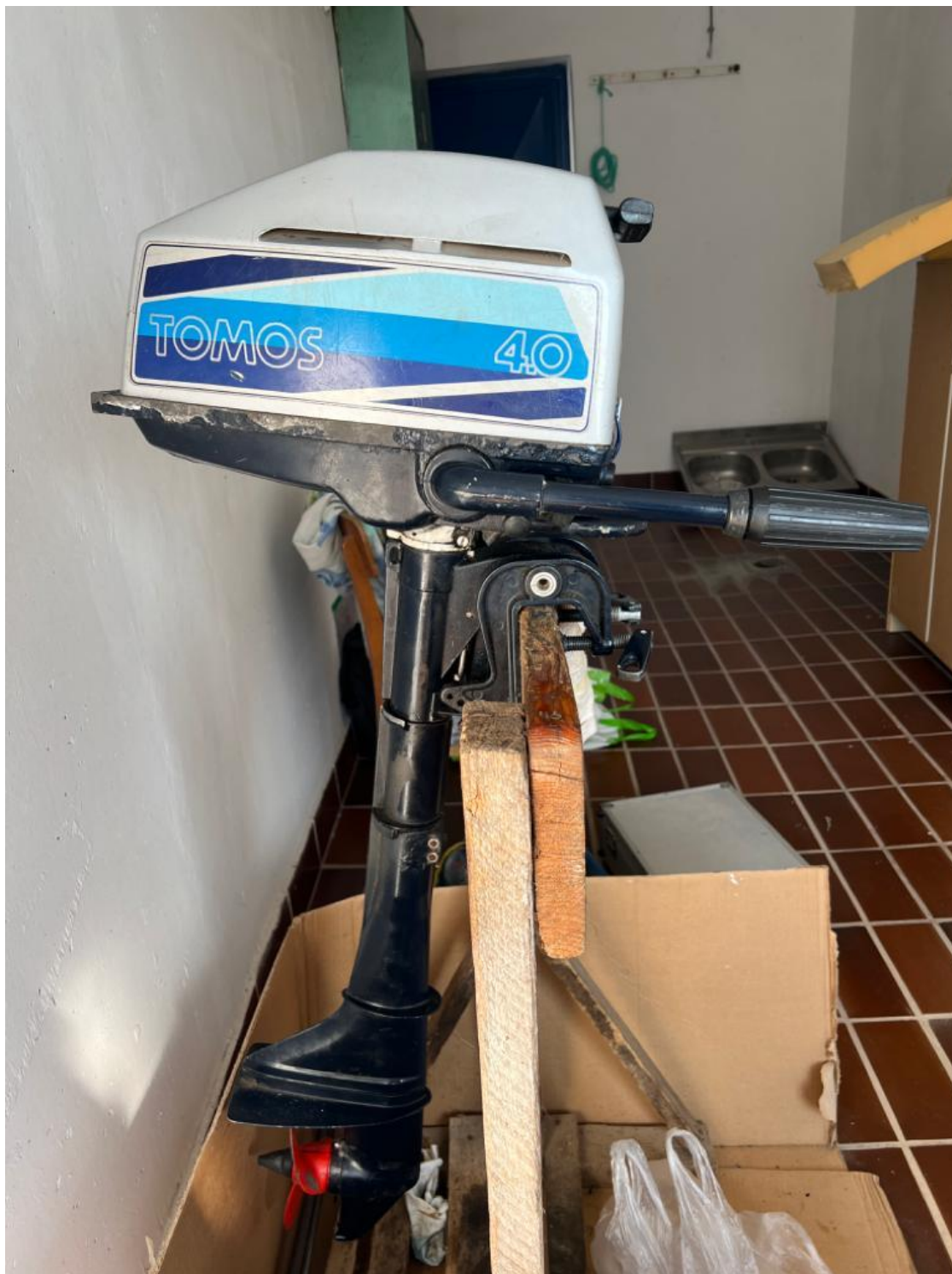
Slika 19. Vanbrodski motor Tomos 4KS
