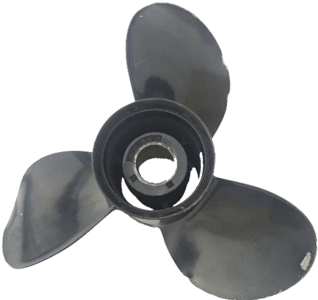
**Slika 18. Oštećeni propeler**
