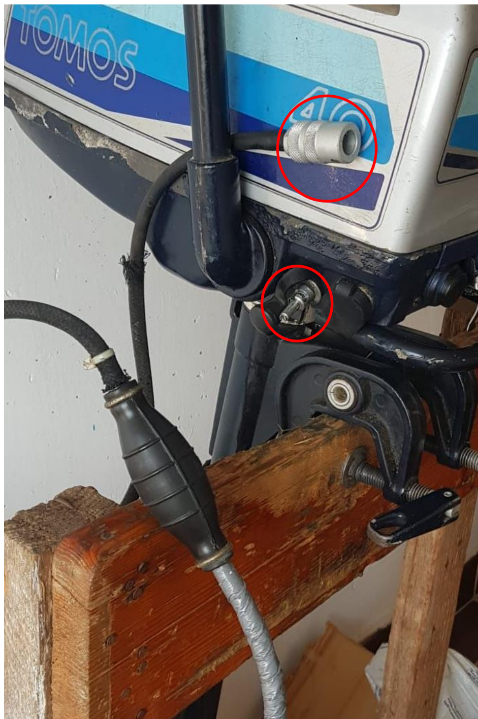
Slika 21. Konektor za dovod goriva
