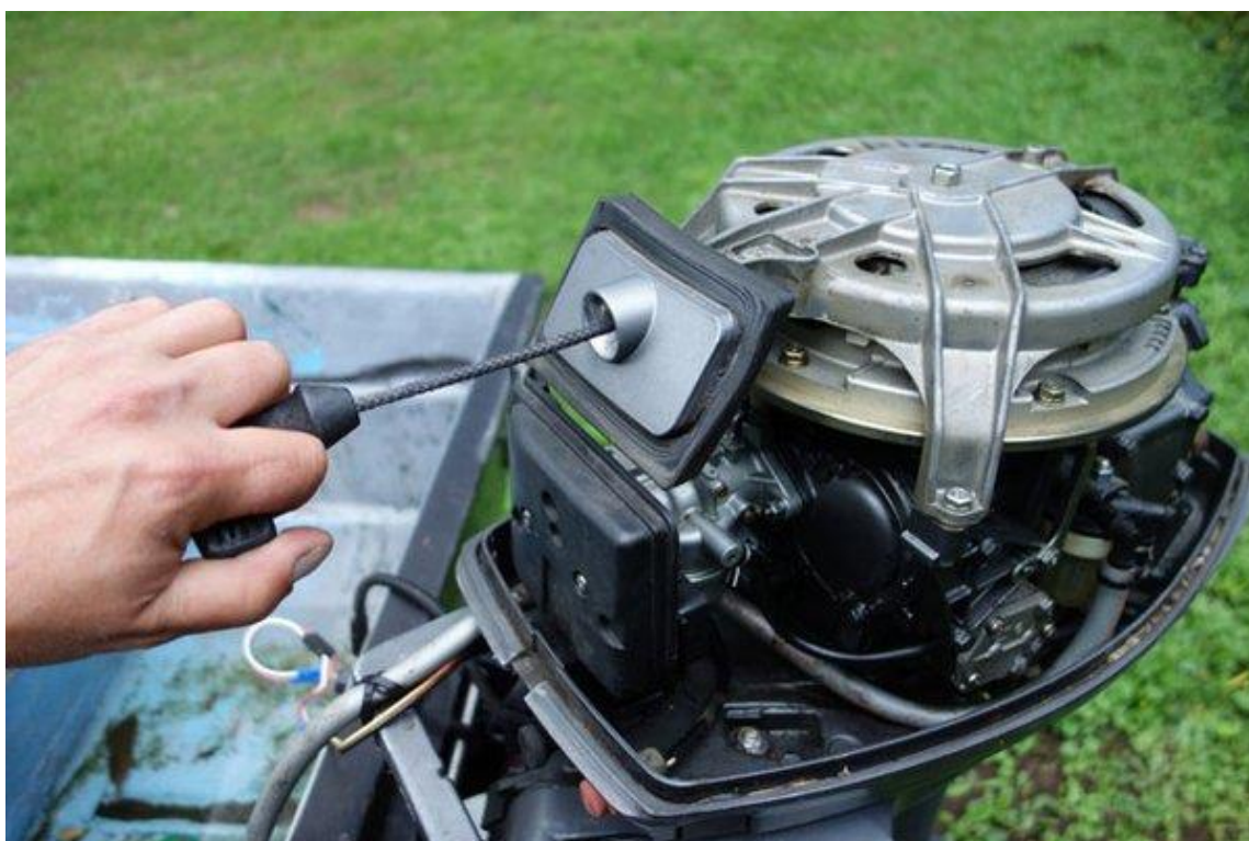
Slika 6. Uže za pokretanje motora
