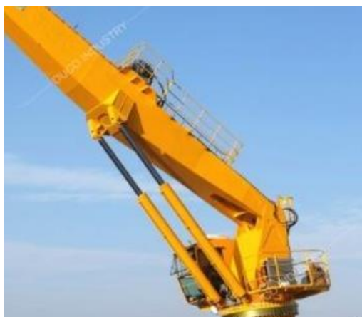
Slika 10 Dohvatnik s hidrauličnim cilindrima [10]
