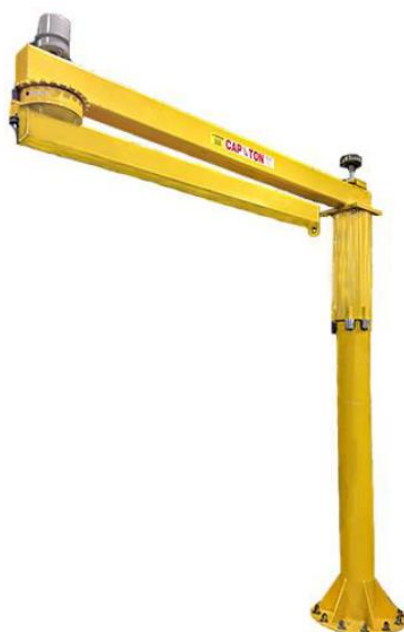
Slika 11 Konzola s dvostrukim pregibom i pogonom za zakretanje [2]
