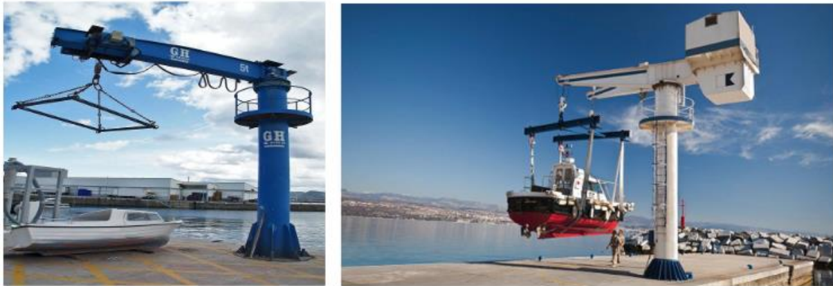
Slika 2 Konzolni granik s a) jednim krakom [4] i b) dva kraka [5]
