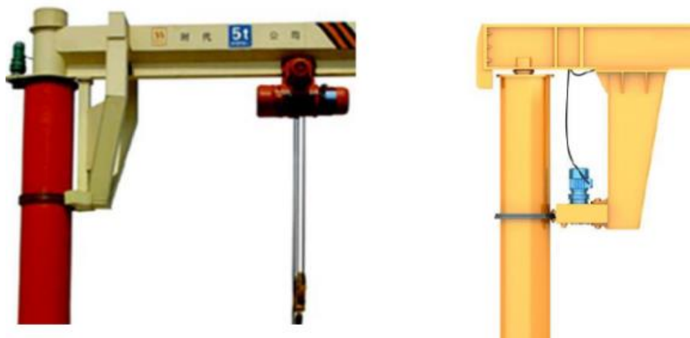
Slika 7 Rotacija konzole s pogonom na a) gornjem osloncu [2] i b) donjem osloncu [2]
