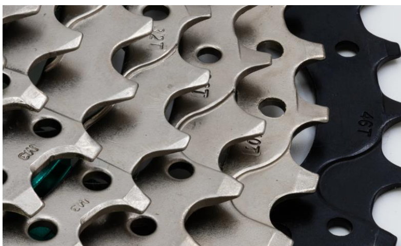
Slika 5: Geometrija lančanika kazete [9]
