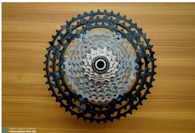
Slika 4: Shimano XTR kazeta u kojoj se primjenjuje više materijala za izradu lančanika [8]
