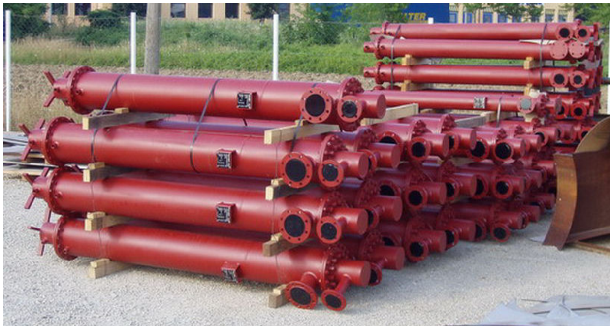
Slika 5.9. Protustrujni tip izmjenjivača s registrom na izvlačenje
