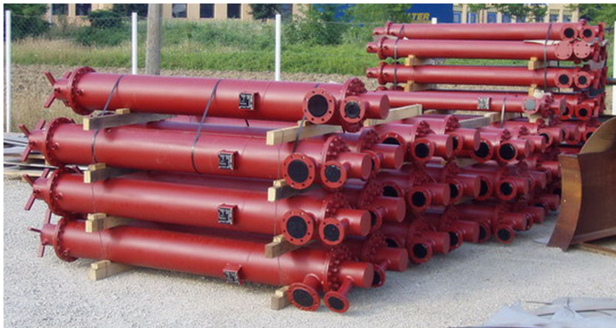
Slika 5.9. Protustrujni tip izmjenjivača s registrom na izvlačenje
