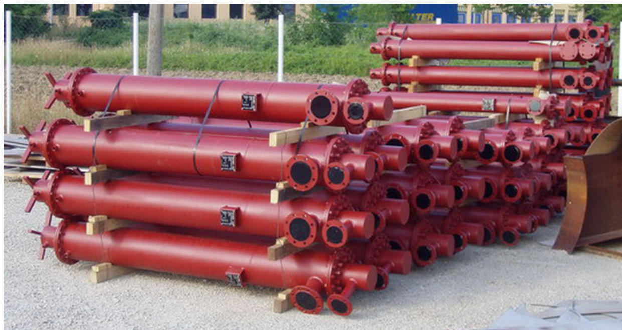
Slika 5.9. Protustrujni tip izmjenjivača s registrom na izvlačenje
