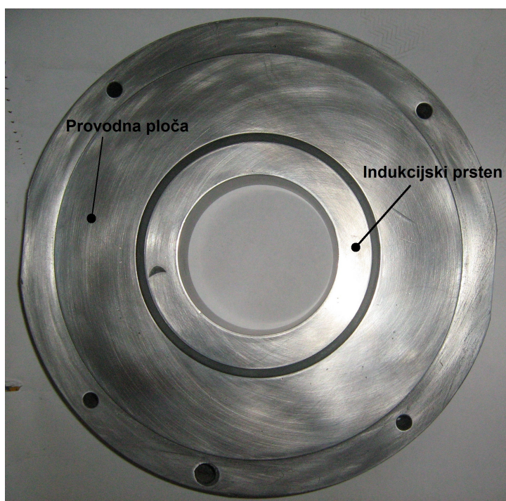
Slika 3.5. Indukcijski prsten uprešan i zavaren na najmanjem radijusu unutar svakog diska okretnog kućišta
