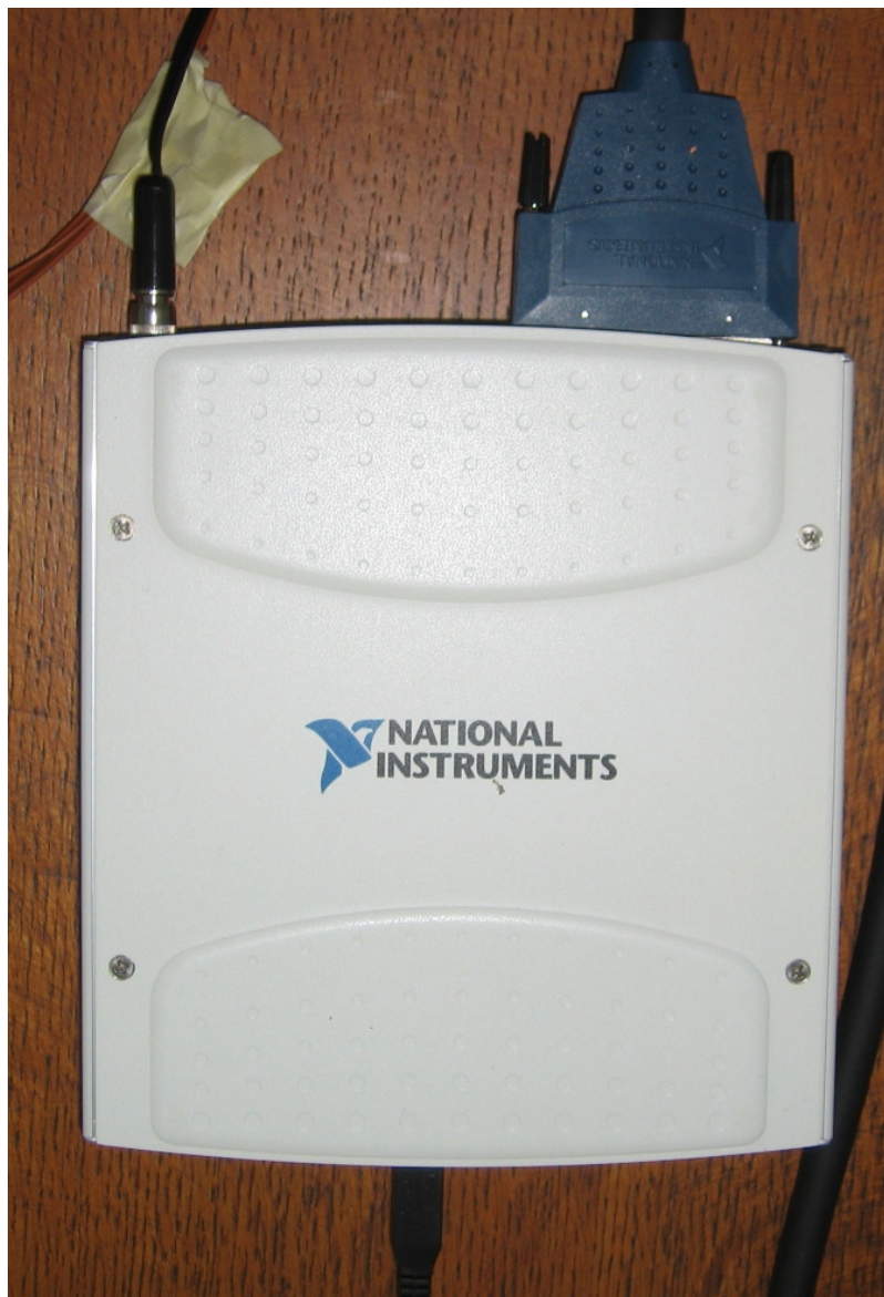
Slika 6.8. Analogno - digitalni pretvarač NI USB 6251
