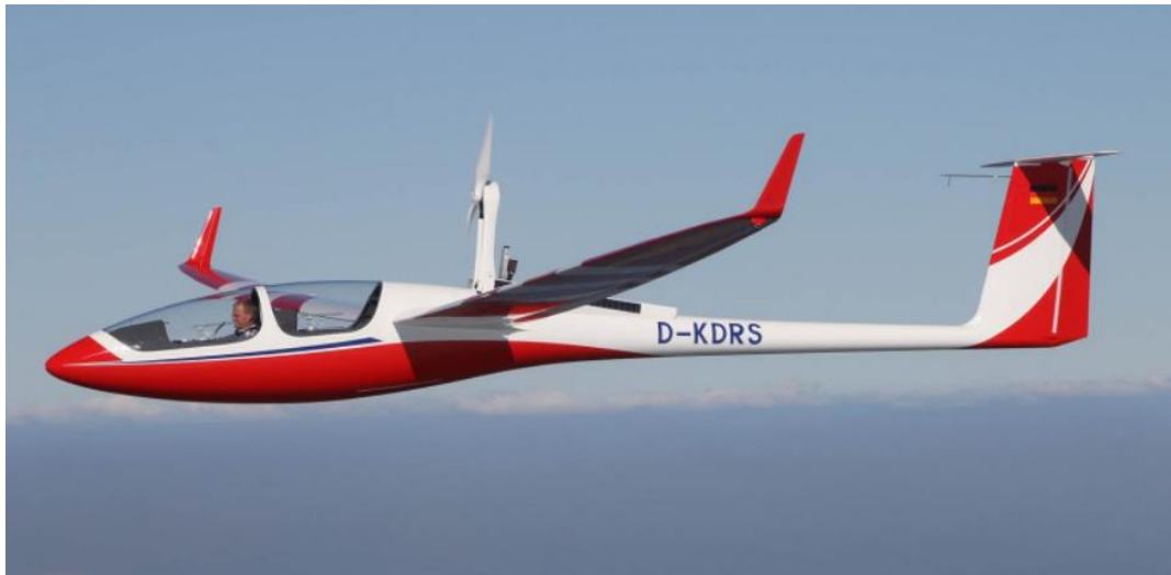
Slika 2. Inačica ASG-32 EL s električnim pogonom [1]
