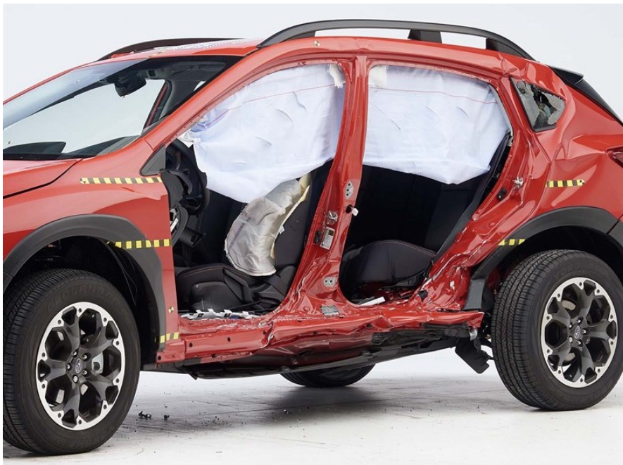
Slika 25. Oštećenje strukture vozila kod bočnog testa [7]
