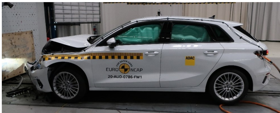
Slika 9. Prikaz oštećenja vozila 1, udar u nepokretnu barijeru [5]
