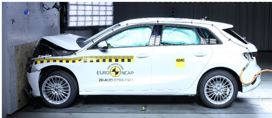
Slika 8. Prikaz oštećenja vozila 1, udar u nepokretnu barijeru [5]
