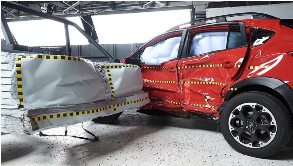
Slika 24. Oštećenje strukture vozila kod bočnog testa [7]
