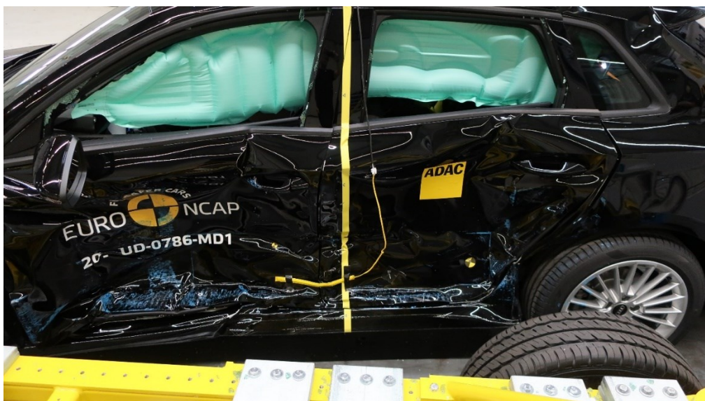
Slika 12. Oštećenje vozila 2, bočni udar [5]
