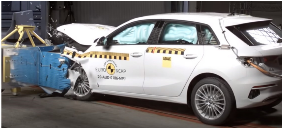
Slika 6. Prikaz oštećenja nosive strukture 2, MPDB test [5]
