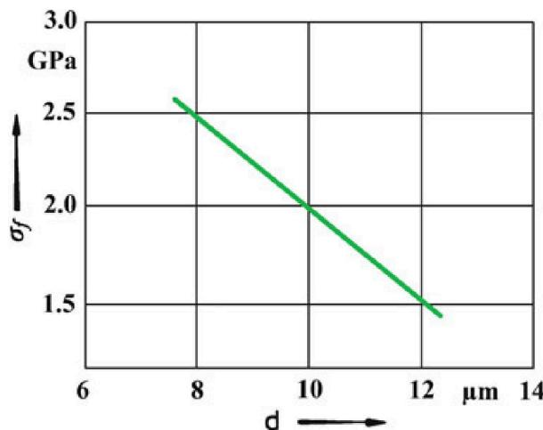
Slika 6. Odnos čvrstoće i promjera kod ugljičnih vlakana [1]
