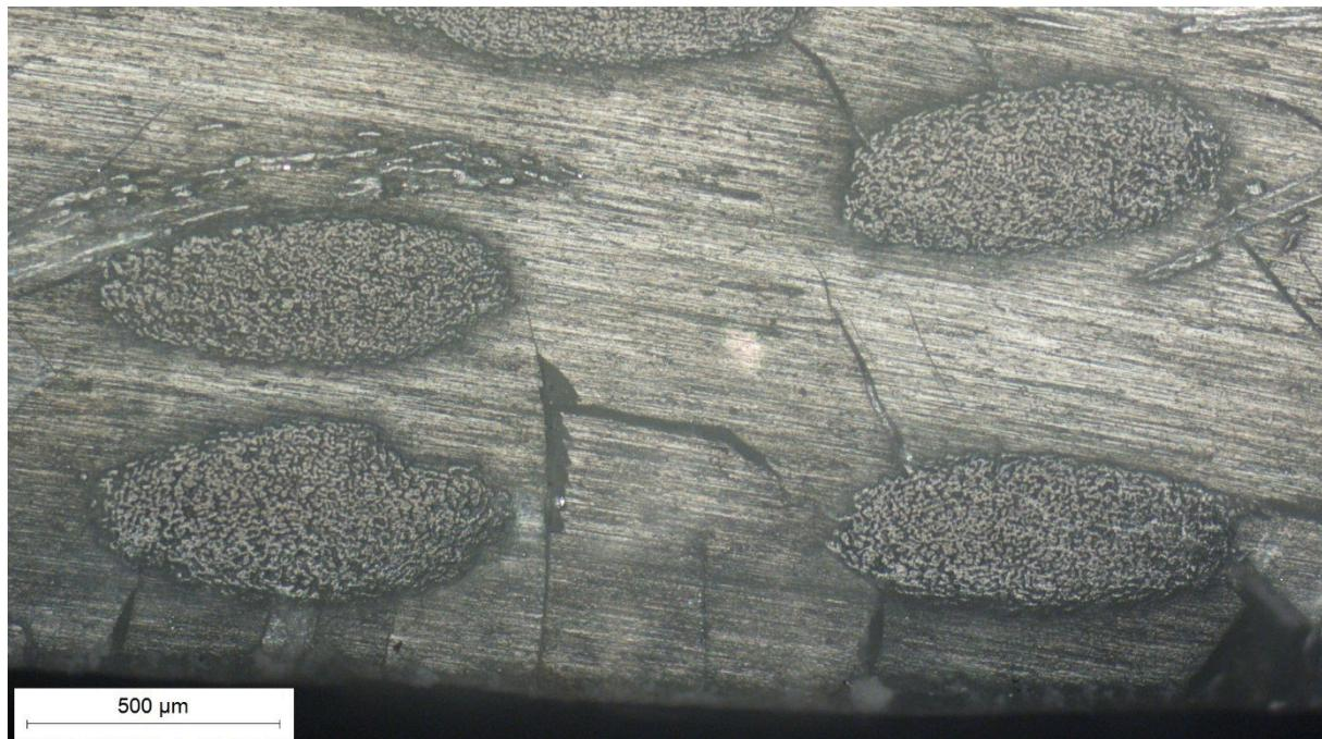
**Slika 37. Presjek PE uzorka na mjestu udara zrna (50:1, pozadina)**
