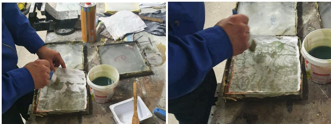
**Slika 20. Slaganje slojeva vlakana i premazivanje**
