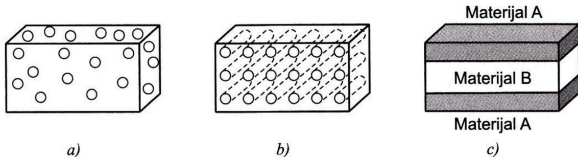
**Slika 2. Osnovni tipovi kompozita: a) kompozit ojačan česticama, b) kompozit ojačan vlaknima, c) struktturni kompozit [1]**
