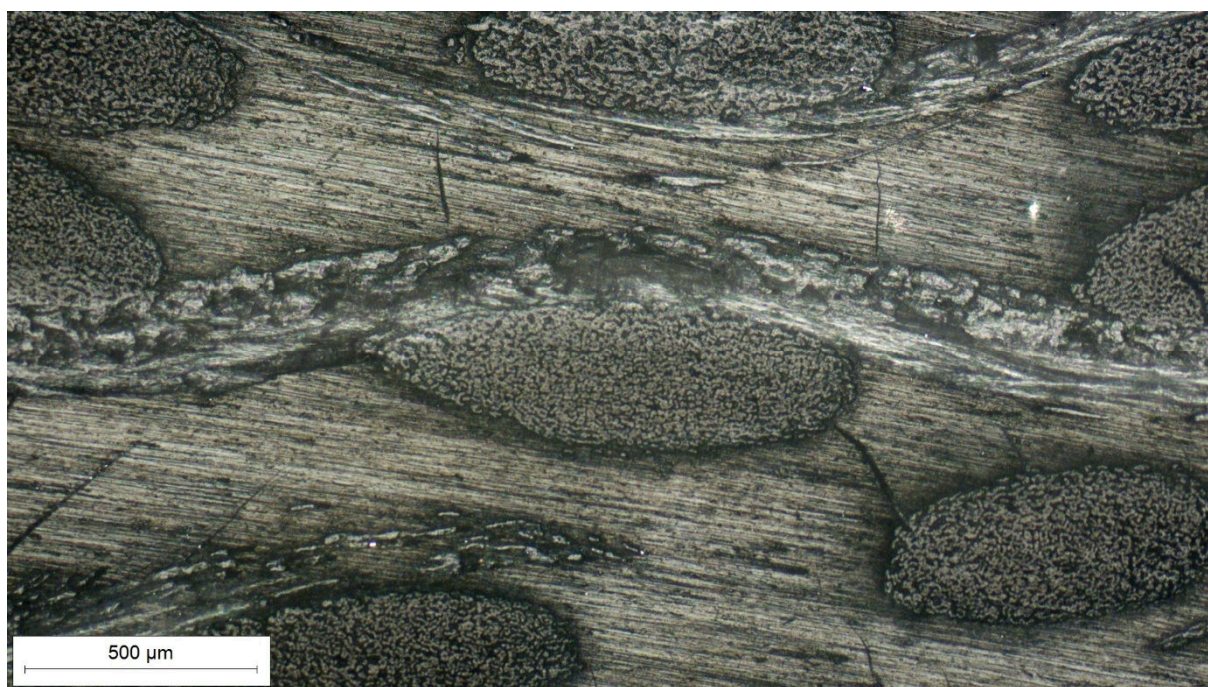
Slika 36. Presjek PE uzorka na mjestu udara zrna (50:1, sredina)
