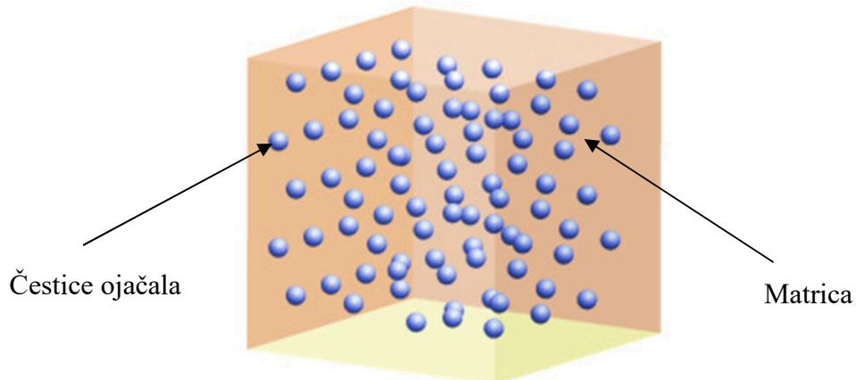
**Slika 3. Shematski prikaz kompozita ojačanog česticama [3]**
