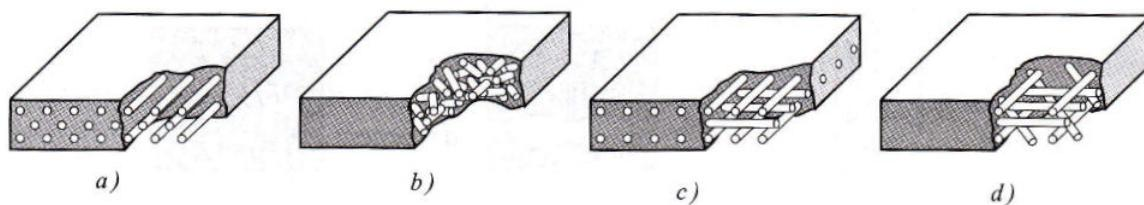
**Slika 7. Različiti načini rasporeda vlknastih ojačava: a) kontinuirana jednosmjerna vlakna, b) slučajno usmjerena diskontinuirana vlakna, c) ortogonalno raspoređena vlakna, d) višesmjerno usmjerena vlakna [2]**
