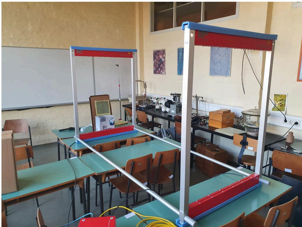
**Slika 23. „B472-ST Precision Light Screen“ okvir za mjerjenje brzine projektila**
