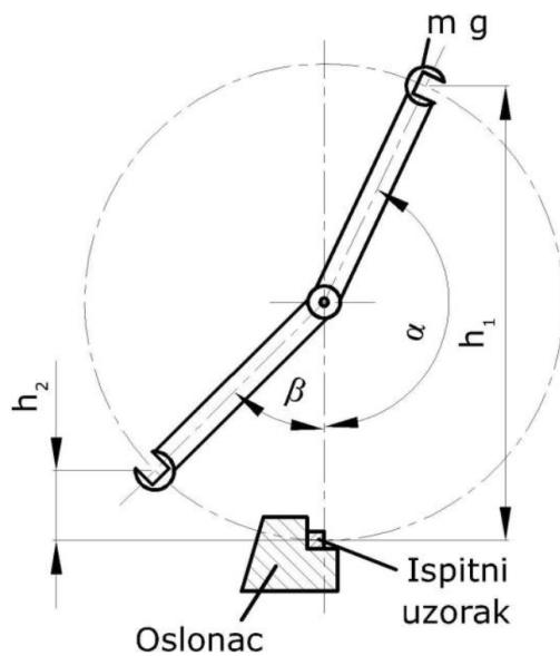
Slika 45. Shematski prikaz rada charpy-evog bata [16]
