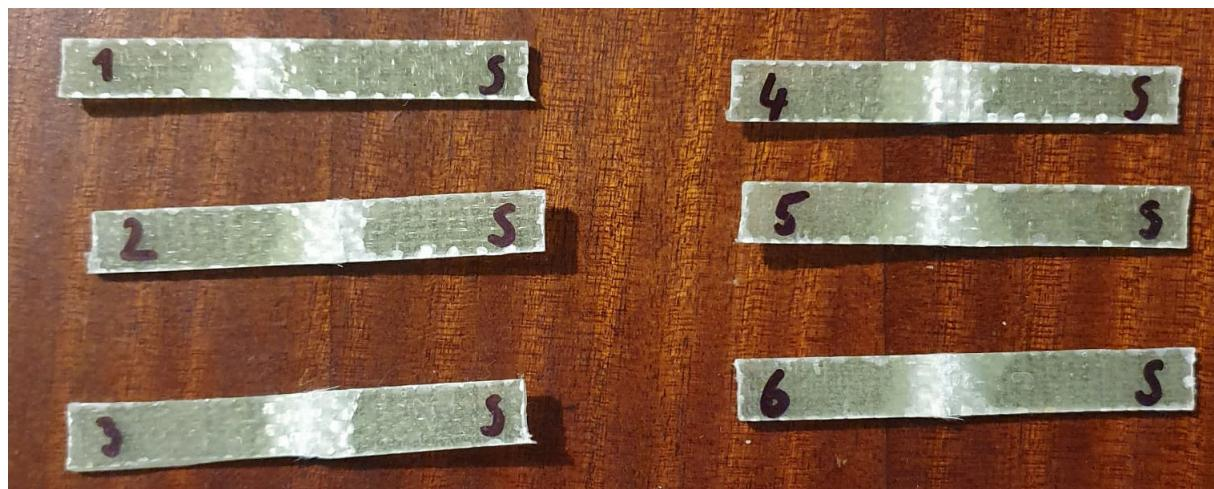
**Slika 48. Epruvete komposta ojačanog staklenim vlaknima nakon ispitivanja žilavosti**
