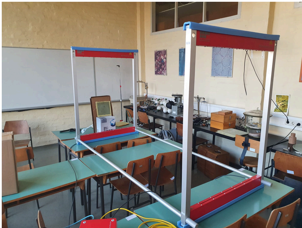
Slika 23. „B472-ST Precision Light Screen“ okvir za mjerenje brzine projektila
