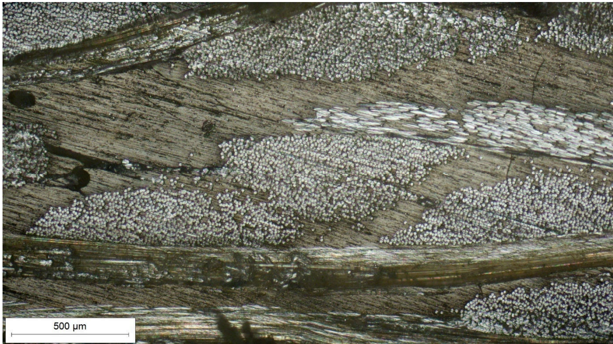
Slika 29. Presjek A uzorka na mjestu udara zrna (50:1, sredina)
