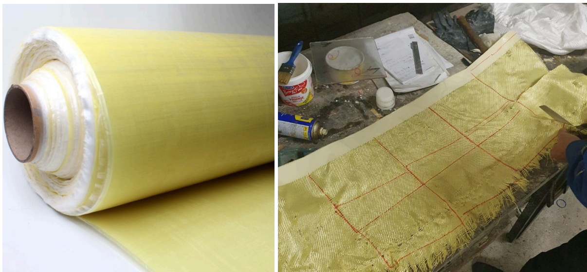
Slika 17. Rezanje tkanine na željeni oblik i dimenzije
