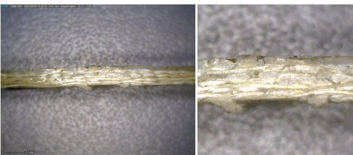
**Slika 27. Presjek A uzorka na mjestu udara zrna (25,2:1 i detalj)**
