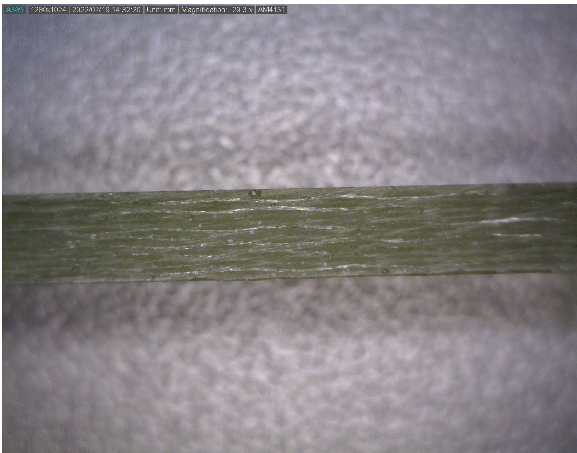
Slika 40. Presjek uzorka S (29,3:1)
