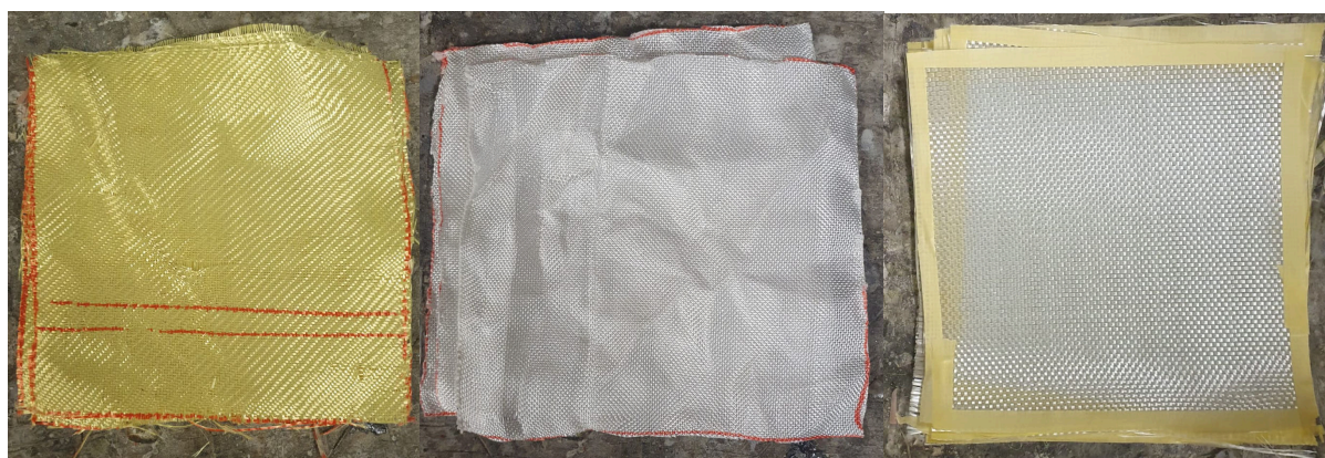
Slika 18. Izrezana tkanina: a) aramidna vlakna, b) polietilenska vlakna, c) staklena vlakna
