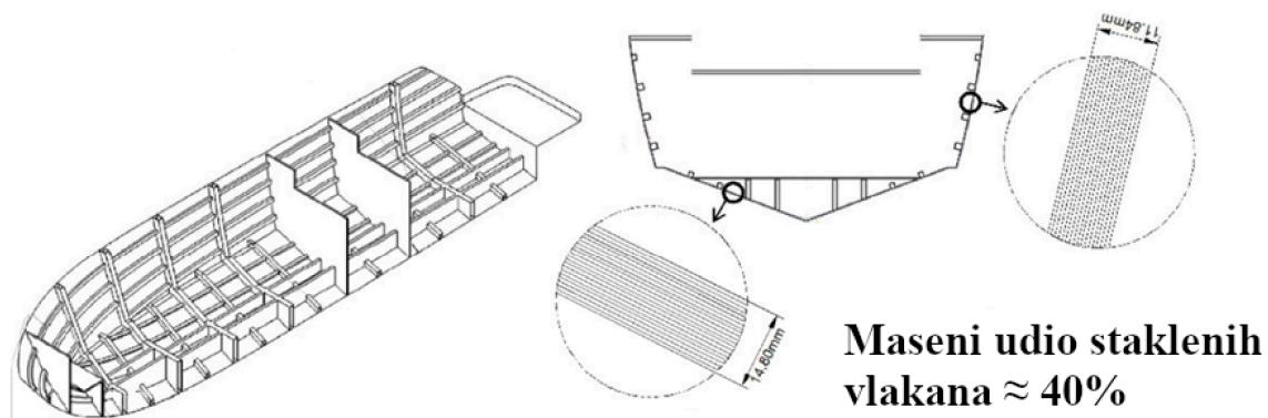
Slika 16. Shematski prikaz broda ojačanog staklenim vlaknima [15]
