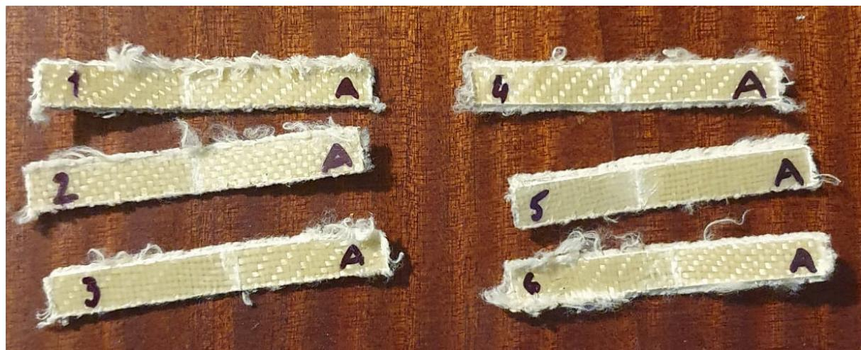
**Slika 46. Epruvete komposita ojačanog aramidnim vlaknima nakon ispitivanja žilavosti**
