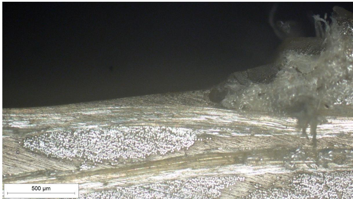
**Slika 28. Presjek A uzorka na mjestu udara zrna (50:1, površina)**
