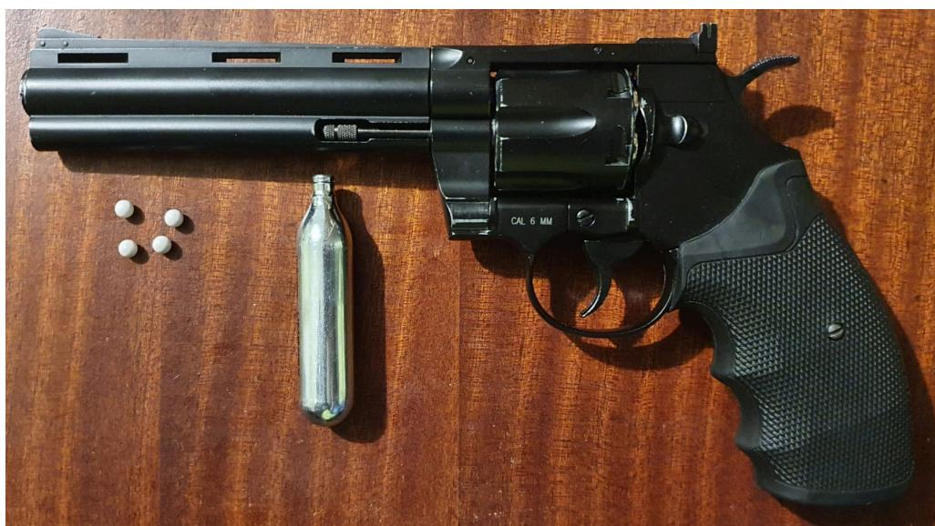
**Slika 22. Pneumatski pištolj, kapsula s plinom i zrna**
