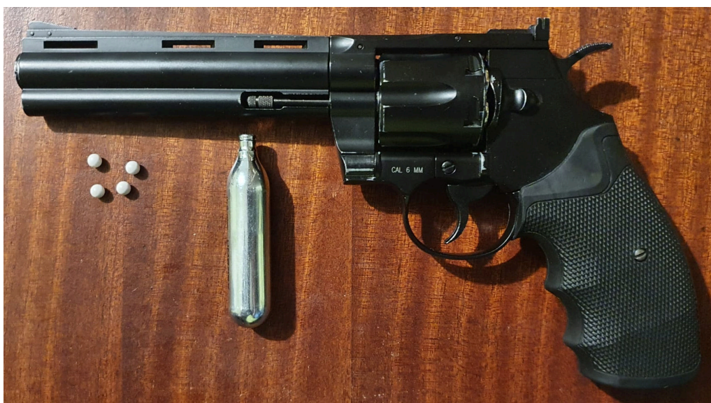
Slika 22. Pneumatski pištolj, kapsula s plinom i zrna
