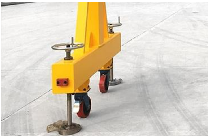
Slika 11. Pomična portalna dizalica s kotačima i stopama
