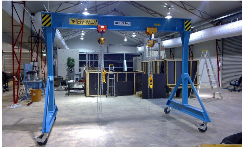
Slika 2. Pomična portalna dizalica
