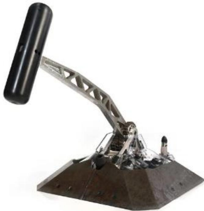
Slika 2. Robot s čekićem
