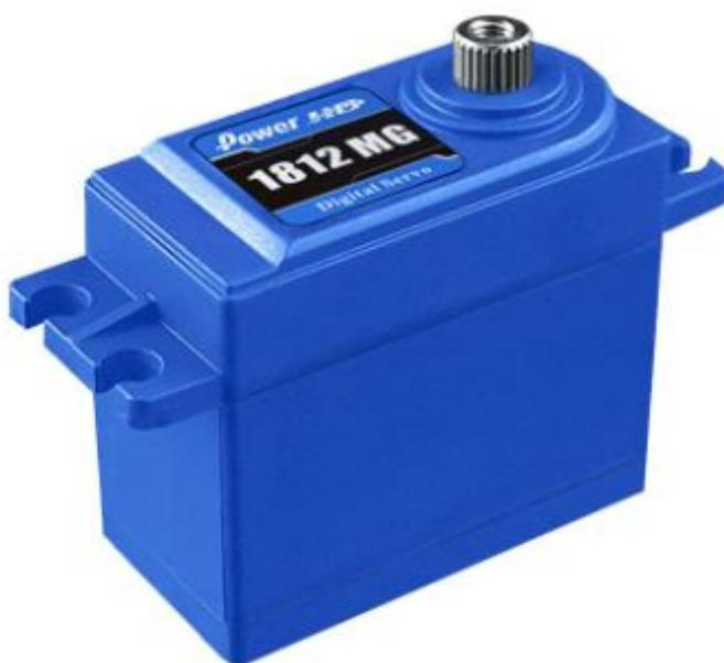
Slika 8. Servomotor
