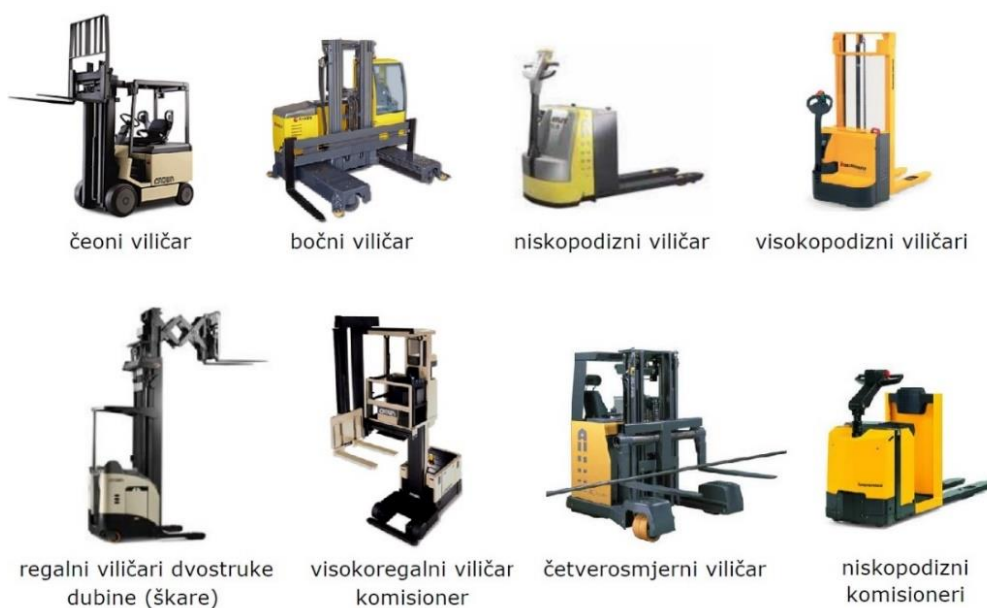
Slika 14. Viličari prema izvedbi
