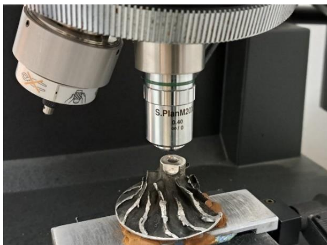
Slika 45. Mjerenje tvrdoće rotora kompresora metodom Vickers
