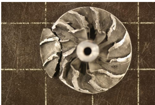
Slika 50. Lom rotora kompresora
