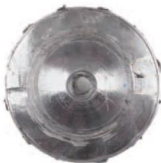
Slika 31. Oštećenja na rotoru kompresora
