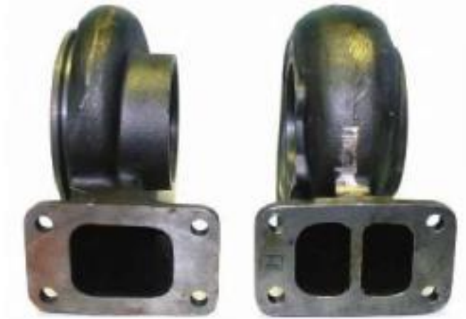
Slika 13. Kućišta turbine od nodularnog lijeva [15]
