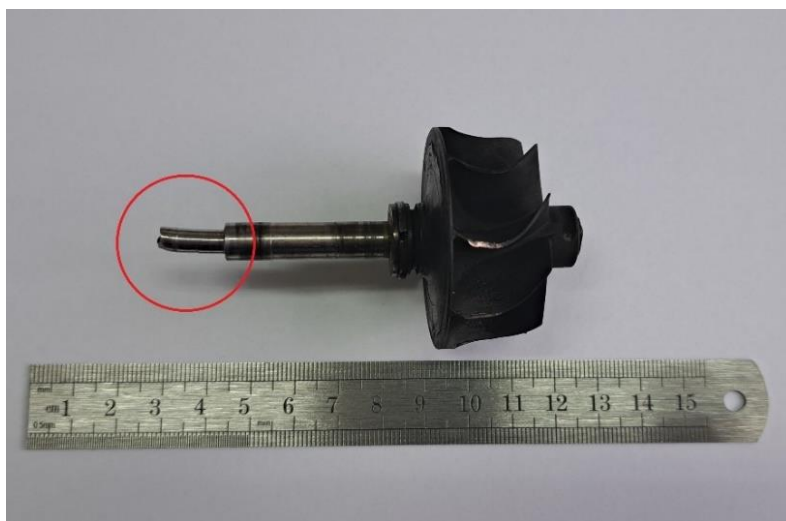
Slika 38. Karakteristični lom spojnog vratila
