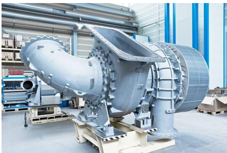
Slika 5. Turbopunjači za brodogradnju [34]
