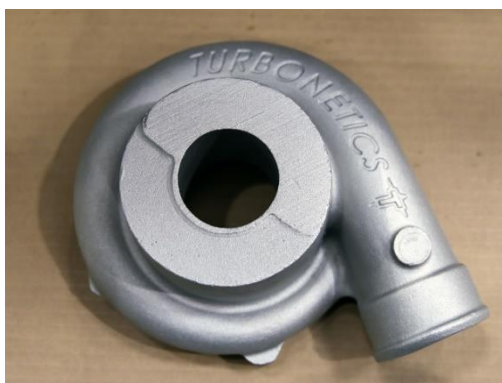
Slika 19. Odljevak kućišta kompresora prije strojne obrade [23]
