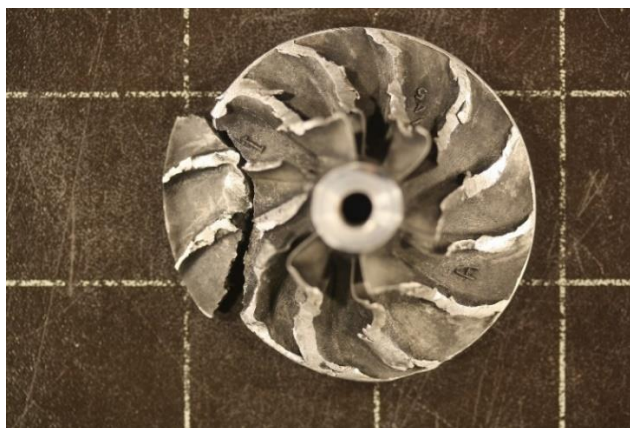
Slika 50. Lom rotora kompresora
