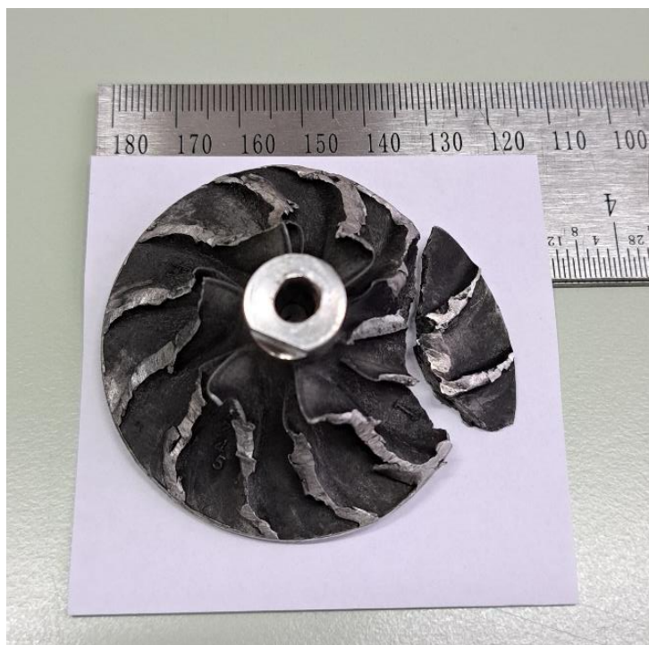
Slika 39. Lom rotora kompresora
