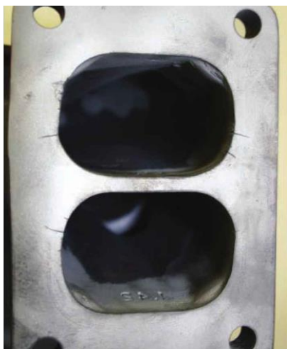
Slika 30. Pukotine na kućištu turbine uslijed visokih temperatura [15]
