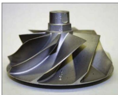
Slika 16. Rotor kompresora sa stalnim promjerom lopatica [15]
