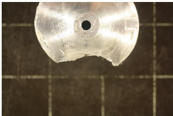
Slika 52. Lomna površina rotora kompresora (pogled u tlocrtu)
