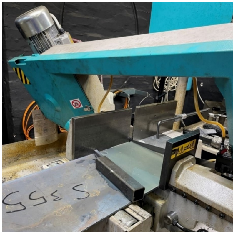
Slika 32. Rezanje ploče osnovnog materijala na tračnoj pili
