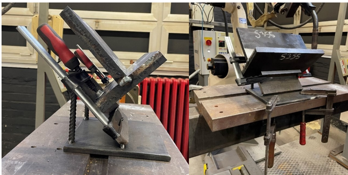
Slika 33. Pozicioniranje uzorka (lijevo) i stezanje na pozicioner (desno)
