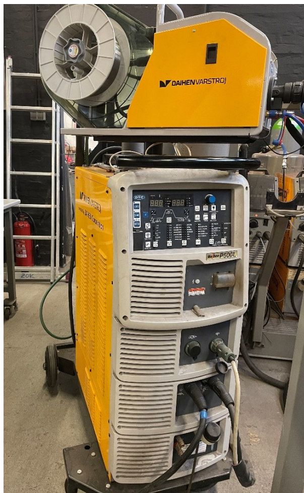
Slika 25. Izvor struje i mehanizam za dovođenje žice
