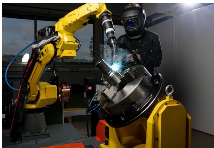
Slika 21. Primjena pozicionera tijekom robotiziranog zavarivanja [35]
