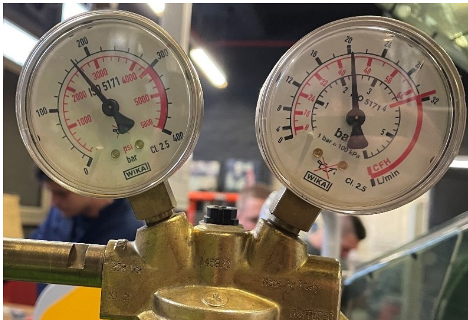
Slika 30. Protok zaštitnih plinova
