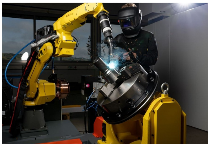
Slika 21. Primjena pozicionera tijekom robotiziranog zavarivanja [35]
