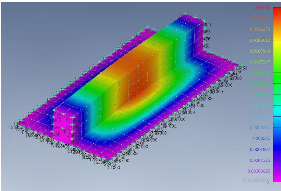
**Slika 60. Deformacije uzdužnjaka dna sa ispunom pjene**
