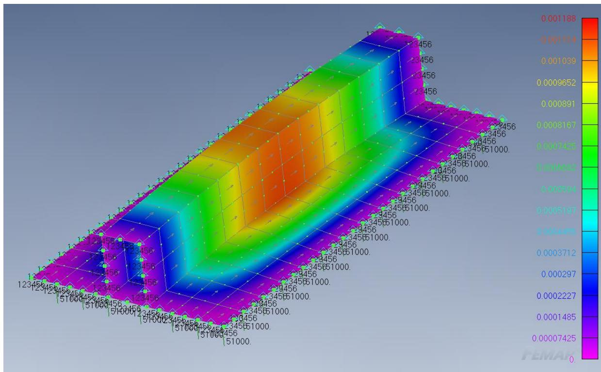
**Slika 59. Deformacije uzdužnjaka dna bez ispune Foam PET materijalom**
