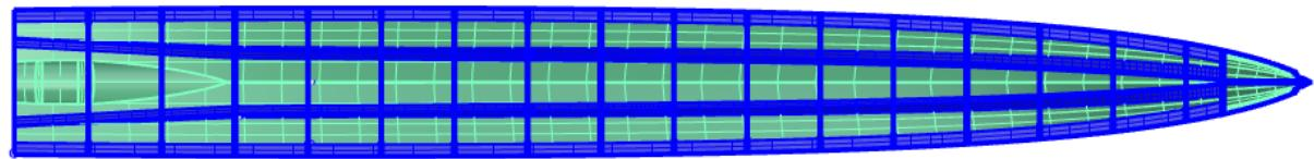
Slika 12. Uzdužni presjek na vodnoj liniji trupova
