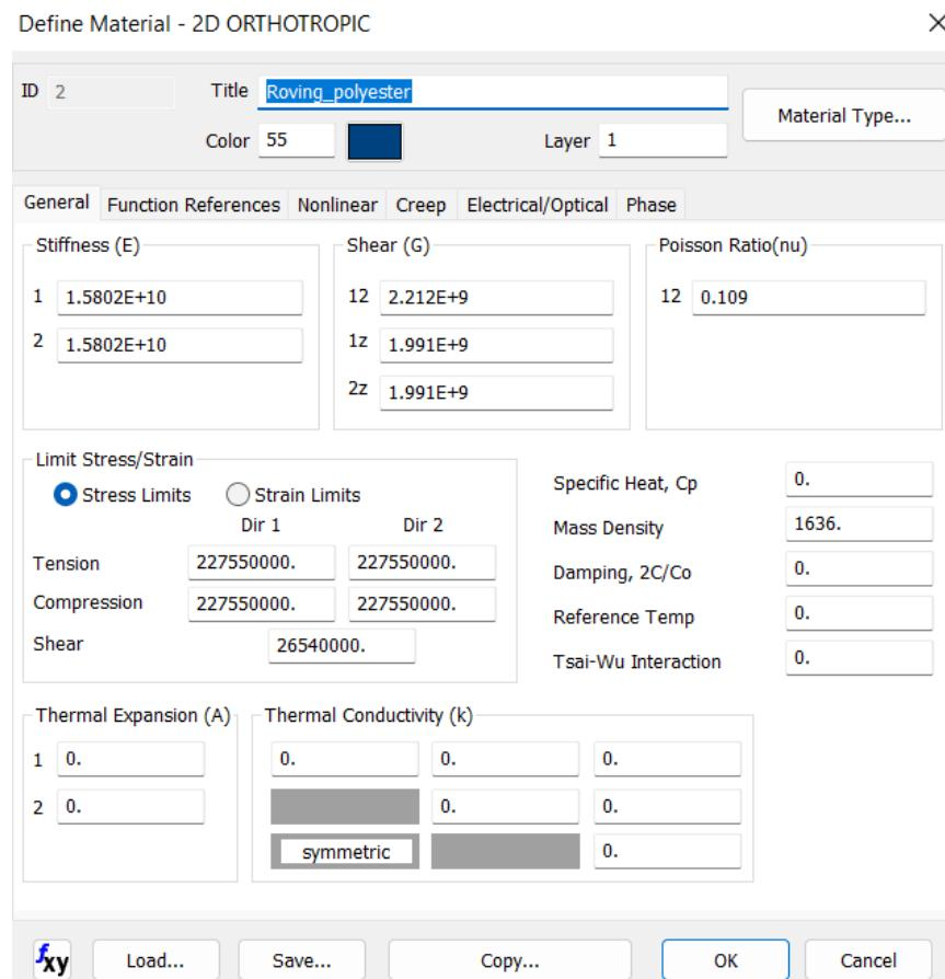
**Slika 23.** Svojstva materijala Roving1200 kompozita ojačanih sa 50% staklenih vlakana sa poliesterskom matricom definirana u Femap/NX Nastran
