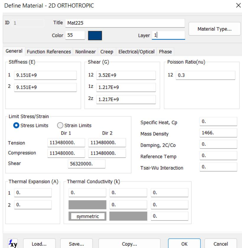
**Slika 25. Svojstva materijala Mat225 kompozita ojačanih sa 34% staklenih vlakana sa poliesterskom matricom definirana u Femap/NX Nastran**
