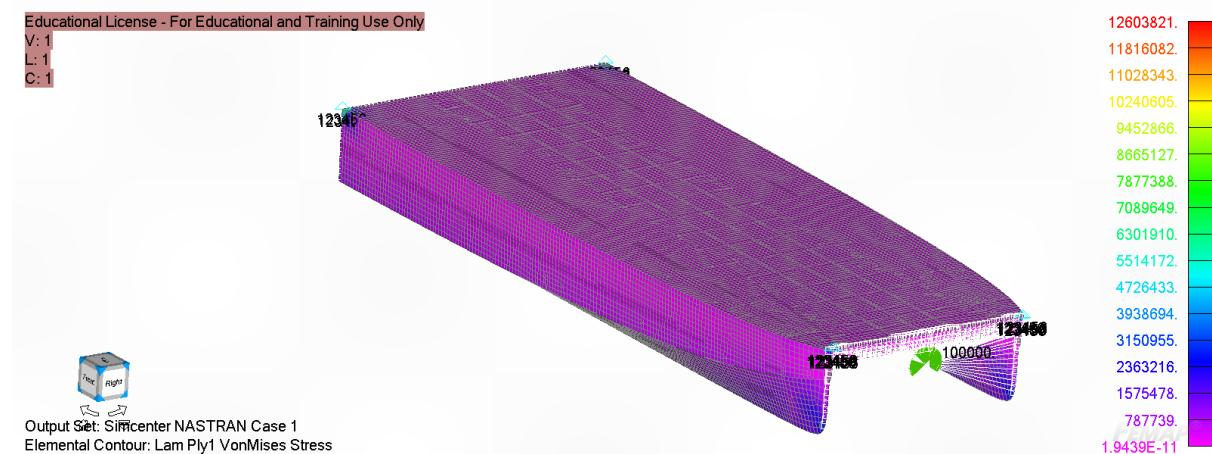
**Slika 89.** Prikaz Von Mises naprezanja u najgornjem sloju svakog laminata
