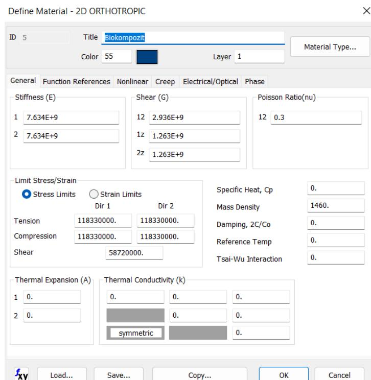
**Slika 27. Svojstva biokompozita (kompozita eposkid/lan) u Femap/NX Nastranu**
