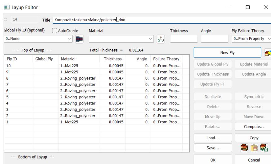
Slika 29. Raspored slojeva kompozita ojačanih staklenim vlaknima sa poliesterskom matricom definiran u Femap/NX Nastranu za oplatu dna
