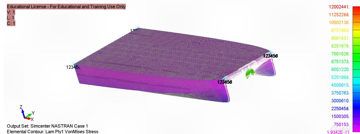
**Slika 91.** Prikaz Von Mises naprezanja u najgornjem sloju svakog laminata
