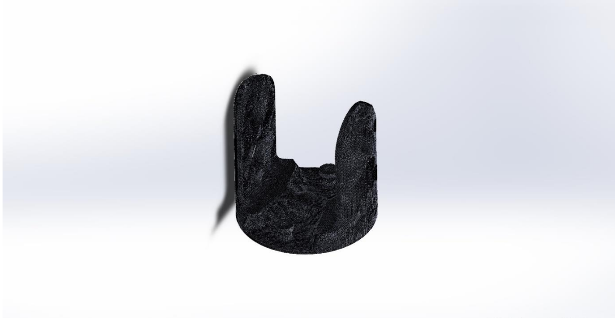
Slika 22. Topološki optimirano rame u programu Solidworks
