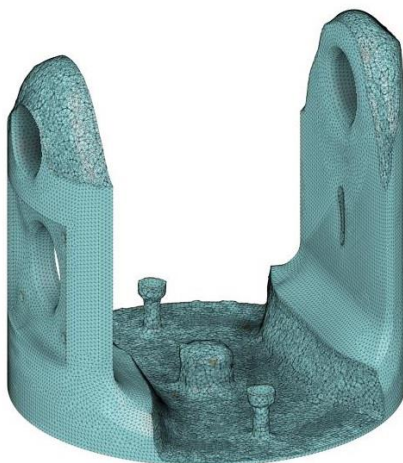
Slika 26. Topološki optimirano rame u programu Fusion 360
