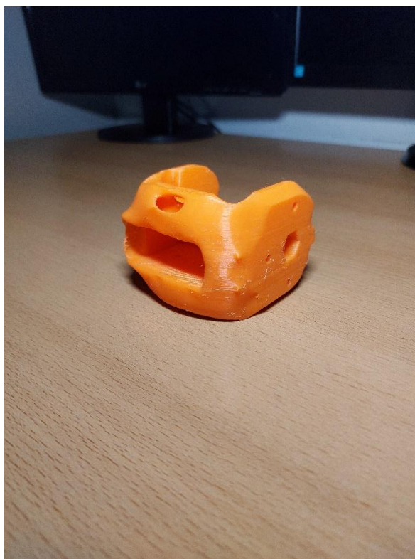
Slika 43. Isprintano optimirano zapešće
