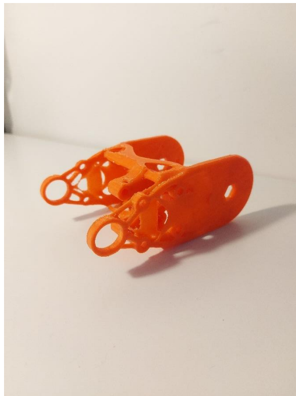
Slika 42. Isprintana optimirana podlaktica
