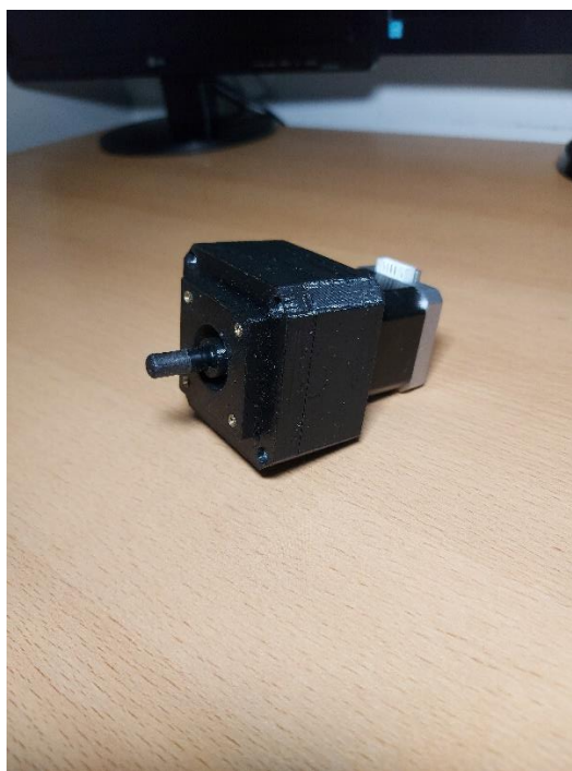
Slika 16. Planetarni reduktor s koračnim motorom
