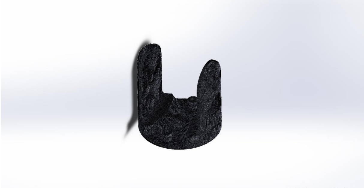
Slika 22. Topološki optimirano rame u programu Solidworks
