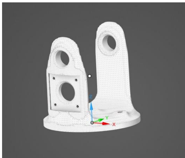
Slika 37. Topološki optimirano rame u programu Ansys Discovery
