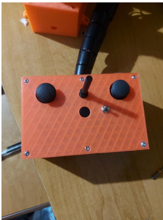
Slika 21. Upravljačka kutija robota
