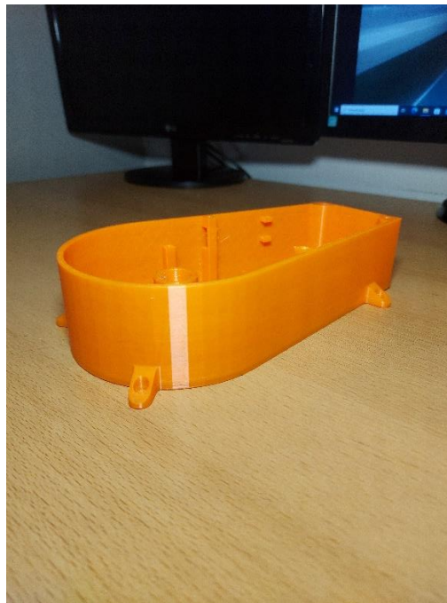
Slika 19. Isprintana baza robota
