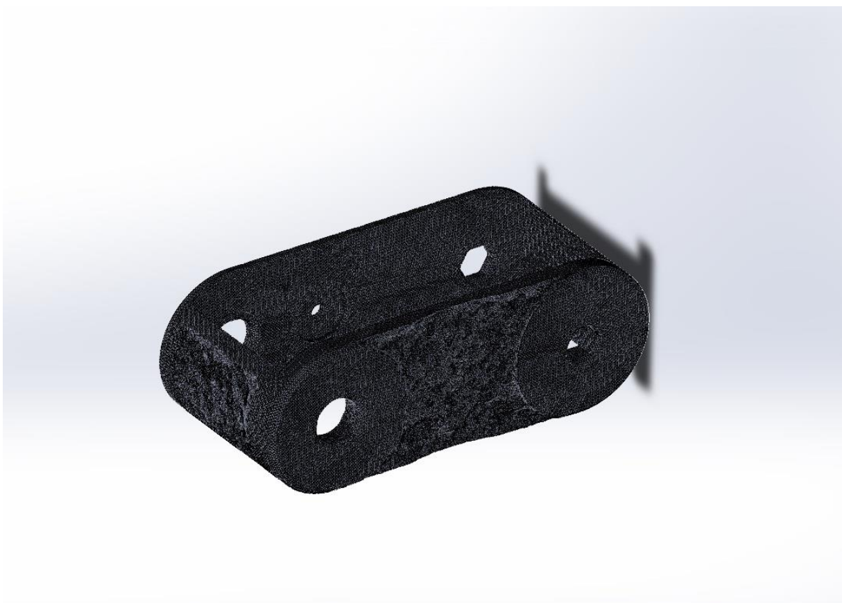
Slika 22. Topološki optimirano rame u programu Solidworks
