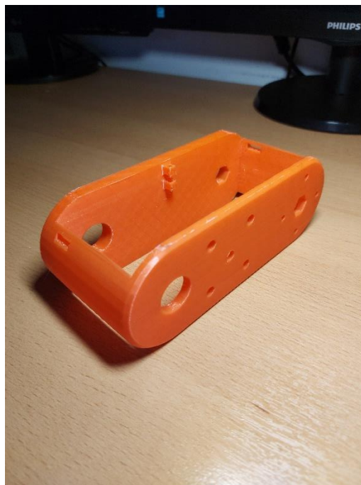
Slika 20. Isprintana nadlaktica robota
