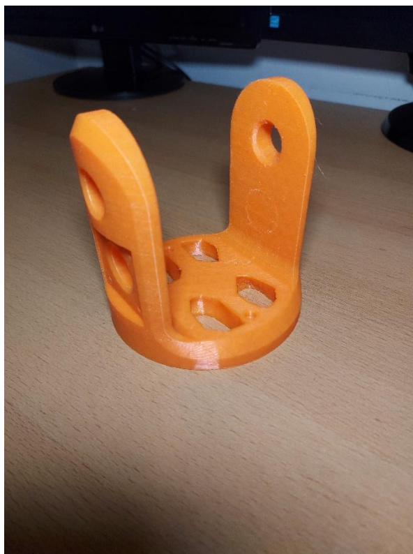
Slika 41. Isprintano optimirano rame
