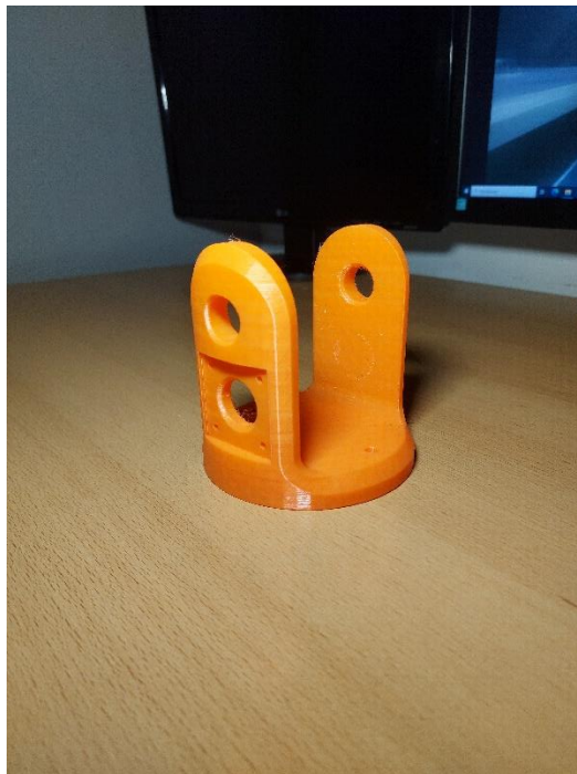
Slika 17. Isprintano rame robota
