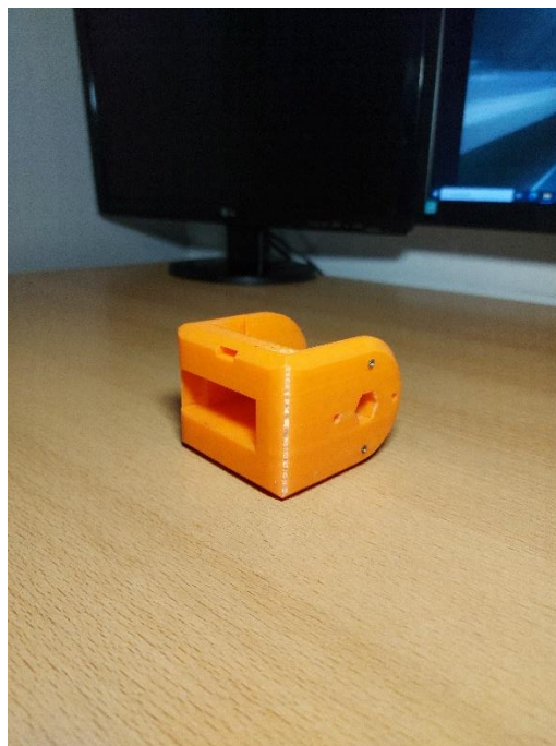
Slika 17. Isprintano rame robota
