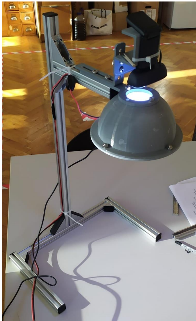
Slika 18. Nosač s kupolnim svjetlom i kamerom
