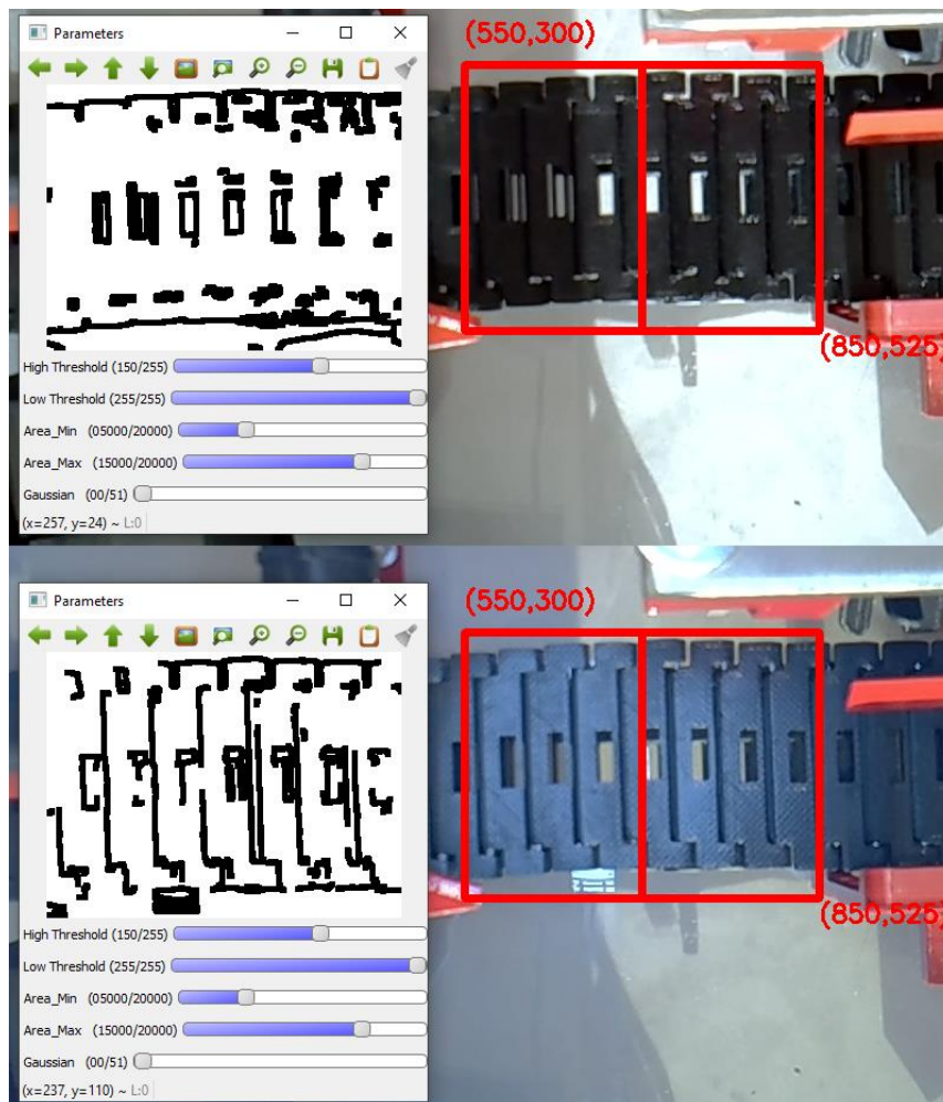
Slika 19. Usporedba slike s i bez primjene osvjetljenja
