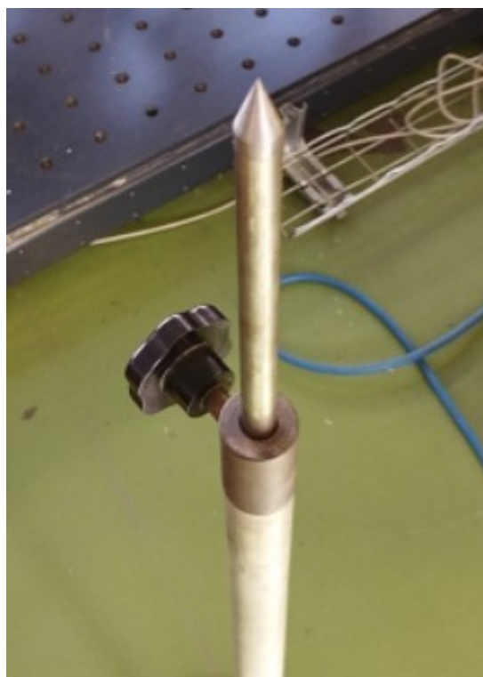
Slika 30. Fiksni šiljak za umjeravanje
