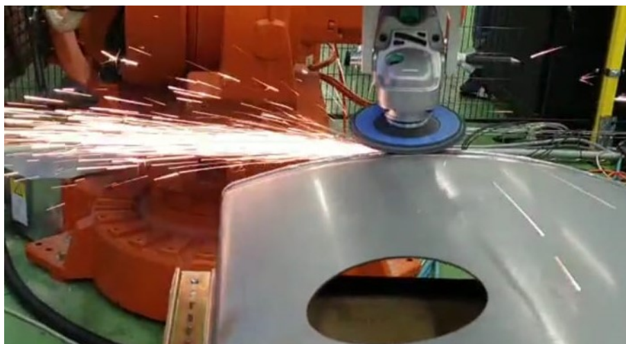
Slika 35. Ispitivanje brušenja zavara
