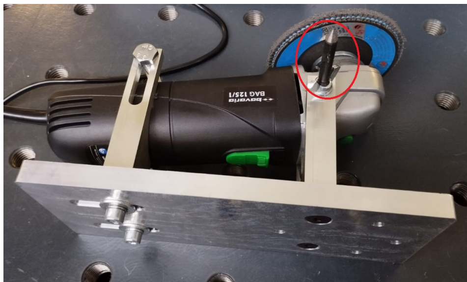
Slika 29. Šiljak montiran na brusilici
