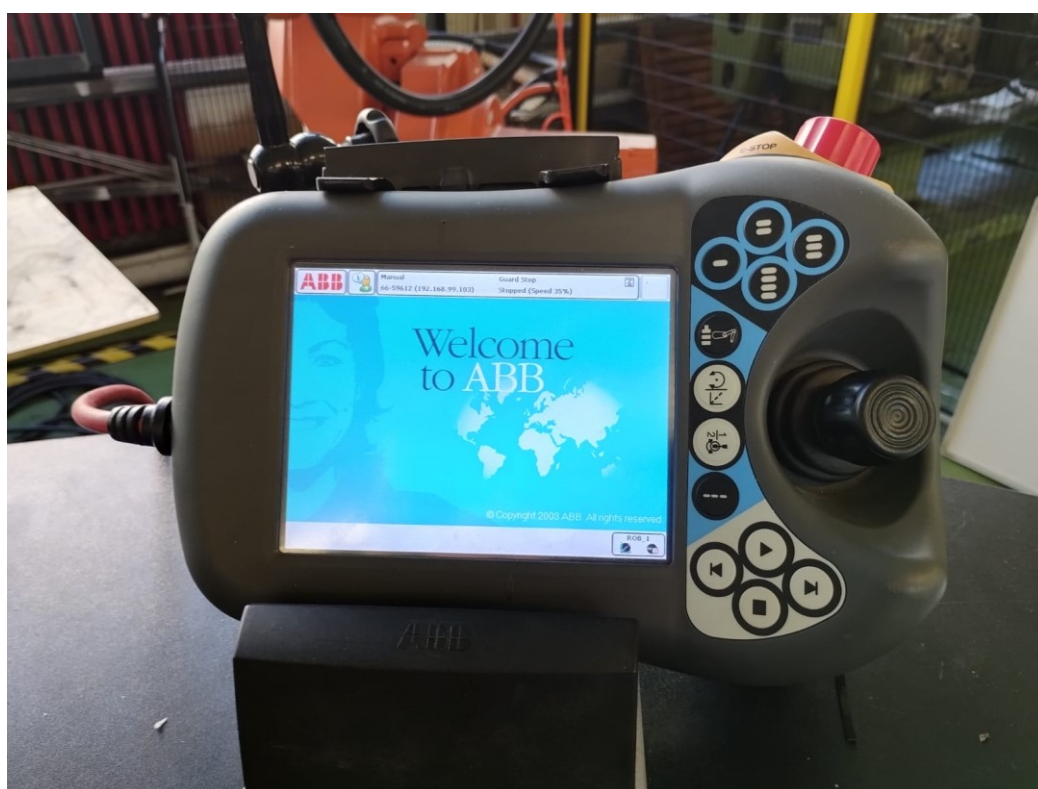
Slika 3. Privjesak za učenje robota ABB IRB 6640-235/2.55
