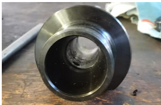
Slika 25. Probušena stezna glava
