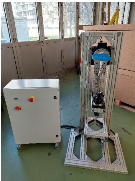
Slika 29. Izrađen postav zračnog tunela
