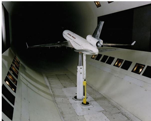
Slika 3. Ispitivanje modela zrakoplova u zračnom tunelu NASA-e [2]
