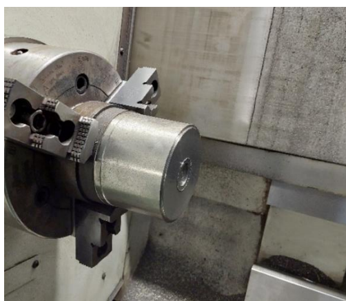
Slika 20. Stezanje priprema u CNC tokarski obradni centar
