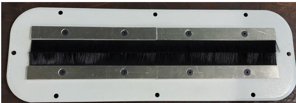
Slika 9. Pogled na metlice na poklopcu upravljačkog ormara izvana
