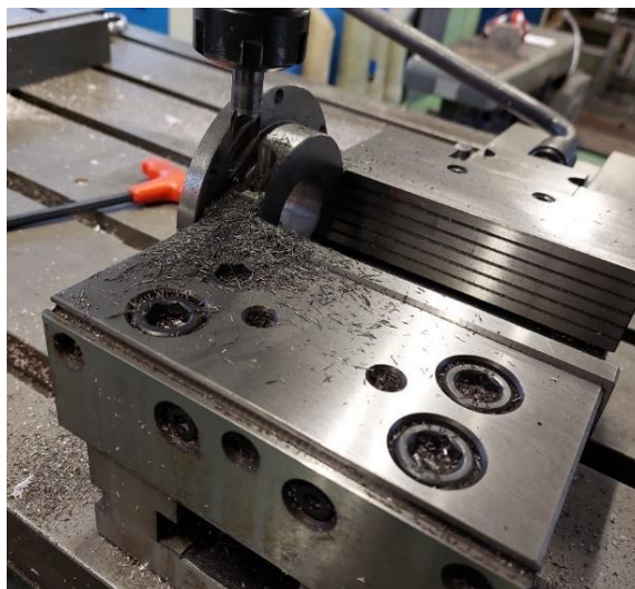
Slika 21. Izrada utora na CNC glodalici
