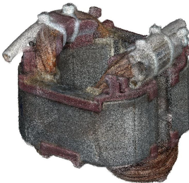
Slika 33. Pojednostavljeni oblak s udaljenosti točaka 0,1 mm
