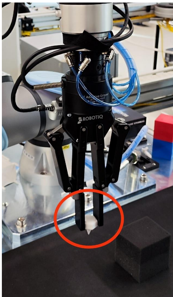
Slika 22. Kalibracijski šiljak stisnut u hvataljci
