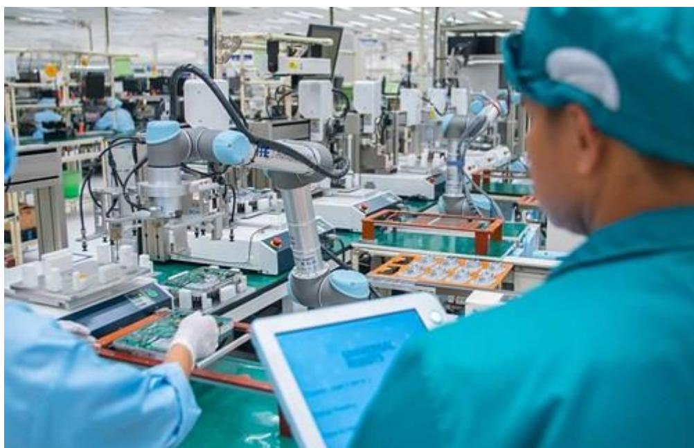
**Slika 3. UR5e robot u industrijskom pogonu**
