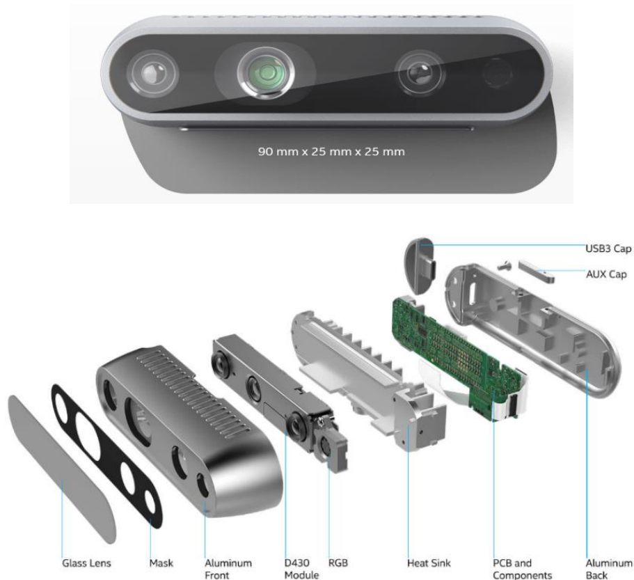
Slika 5. D435i kamera i njezine komponente
