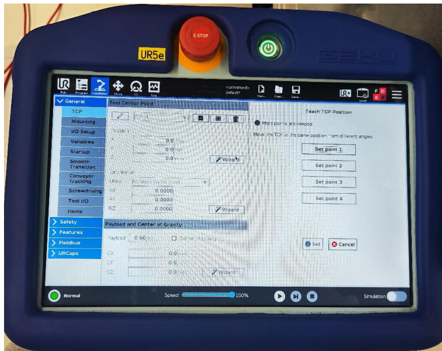
Slika 21. Sučelje za kalibraciju alata unutar kontrolera UR5e
