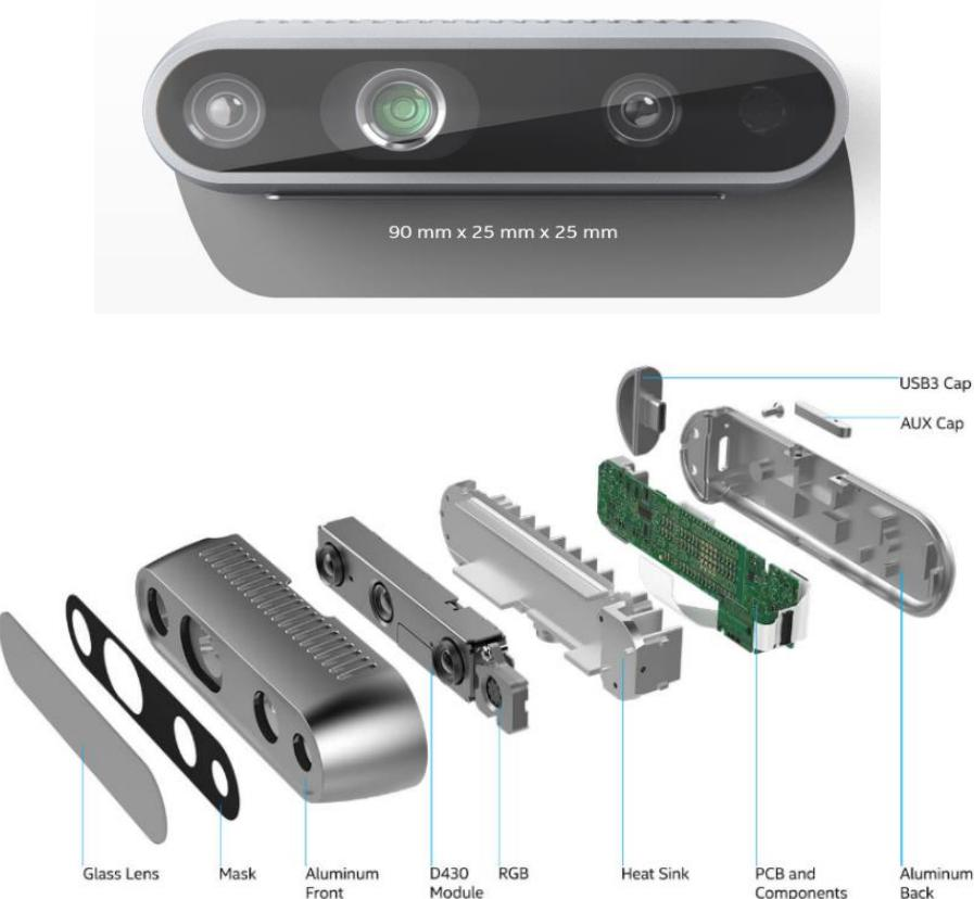
**Slika 5. D435i kamera i njezine komponente**
