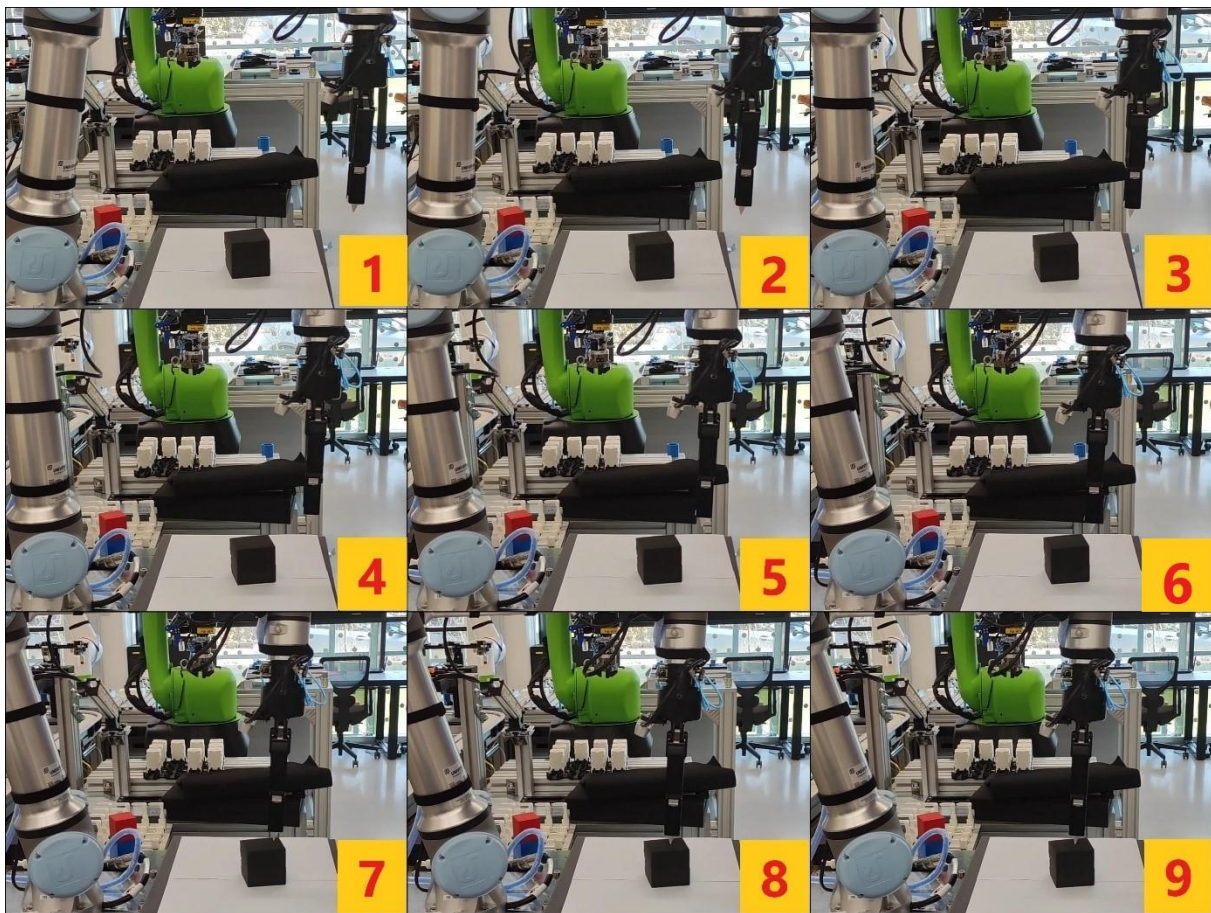
Slika 27. Proces odlaska robota u kontakt s površinom crne kocke
