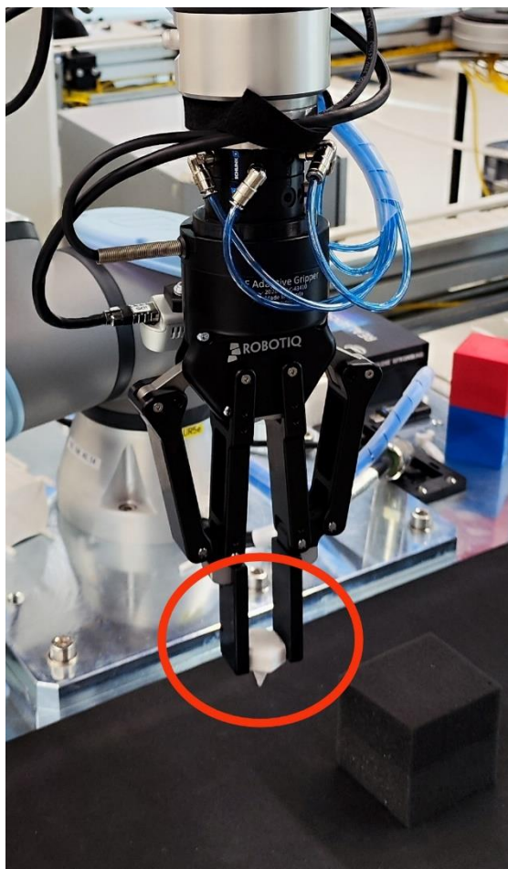
Slika 22. Kalibracijski šiljak stisnut u hvataljci
