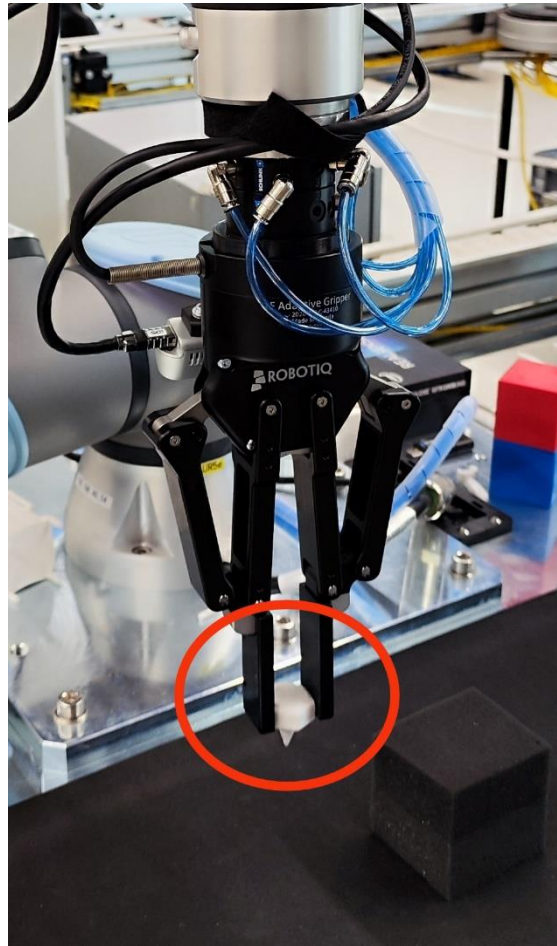
Slika 22. Kalibracijski šiljak stisnut u hvataljci
